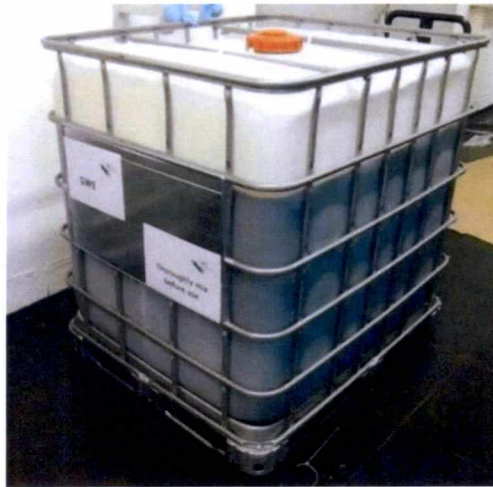
Abb. 13: IBC mit Recyclingpolyol-Gemisch hergestellt aus PUR-PC-WS
