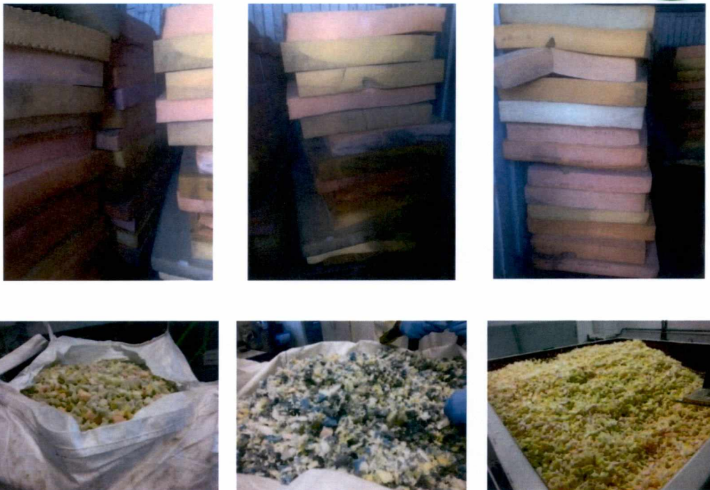
Abb. 12: PUR-PC-WS als ganze Matratzen und in Flockenform (geschreddert)
