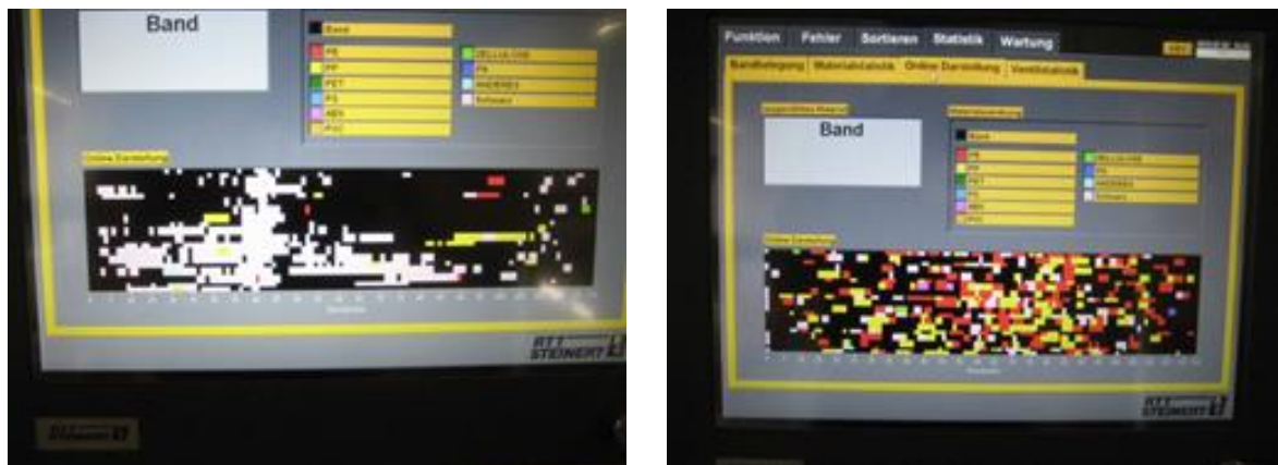
Abbildung 10: Screenshots der Betriebssoftware der Sortieranlage im Sortierbetrieb von stark verstaubtem Trenngut (links) und entstaubtem Trenngut (rechts); die detektierten Schwarzanteile sind von der Software in Weiss dargestellt.
