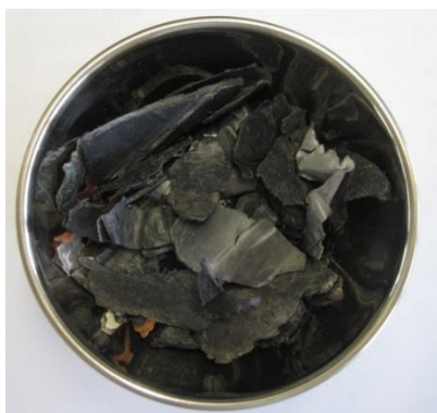
Abbildung 16: Fotografie des aussortierten Materialteilstroms PP (schwarz)
