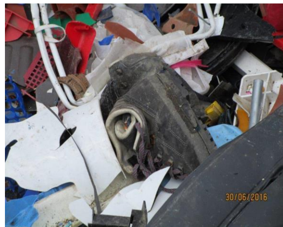
Abbildung 3: Fotografien eines Materialeingangs aus kommunalen Sammlungen von Hartkunststoffen mit hohem Störstoffanteil.
