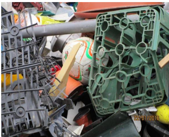
Abbildung 3: Fotografien eines Materialeingangs aus kommunalen Sammlungen von Hartkunststoffen mit hohem Störstoffanteil.
