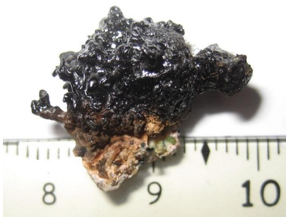
Abbildung 11: Fotografie von verbrannten Störstoffpartikeln im Materialstrom nach Durchlauf der MIR-Sortierung für den Schwarzanteil.
