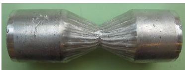
Bild 47: Aluminium-Walzprodukt mit guter geometrischer Qualität.
