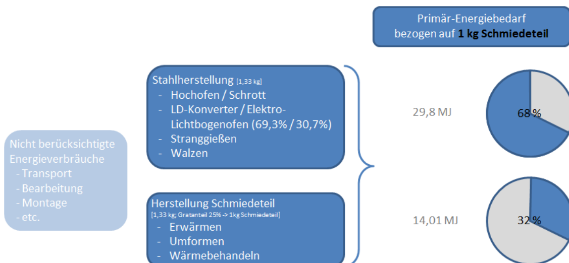
Bild 3: Primärenergiebedarf für die Herstellung von 1 kg Schmiedeteil
