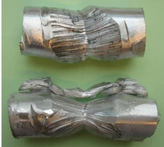
Bild 46: Walzergebnisse der ersten Vorversuche
