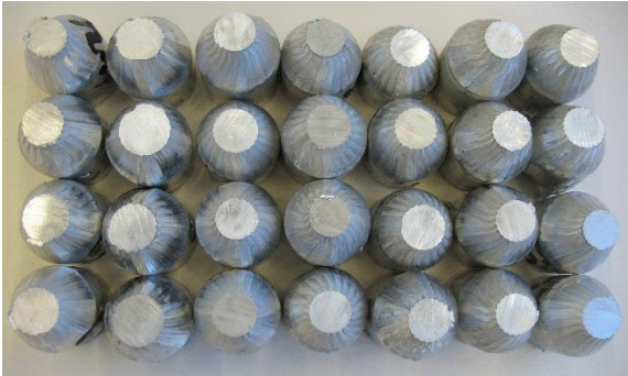
Bild 49: Trennflächen der Aluminium Walzproben
