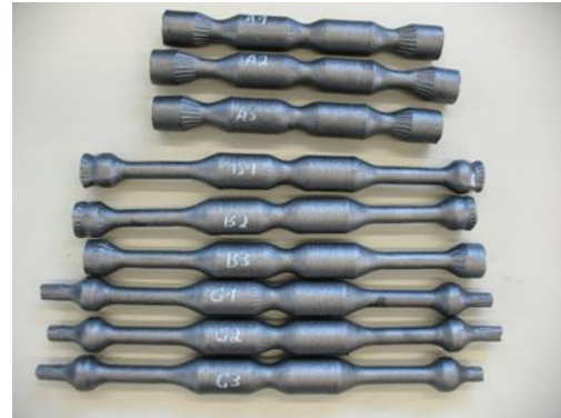
Bild 40: Walzprodukte, Entnahme bei verschiedenen Werkzeugpositionen
