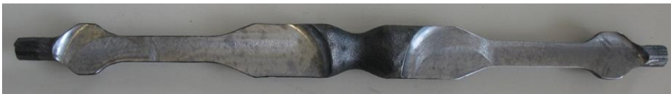
Bild 43: Längsschnitt durch ein Walzstück, keine Innenfehler ersichtlich
