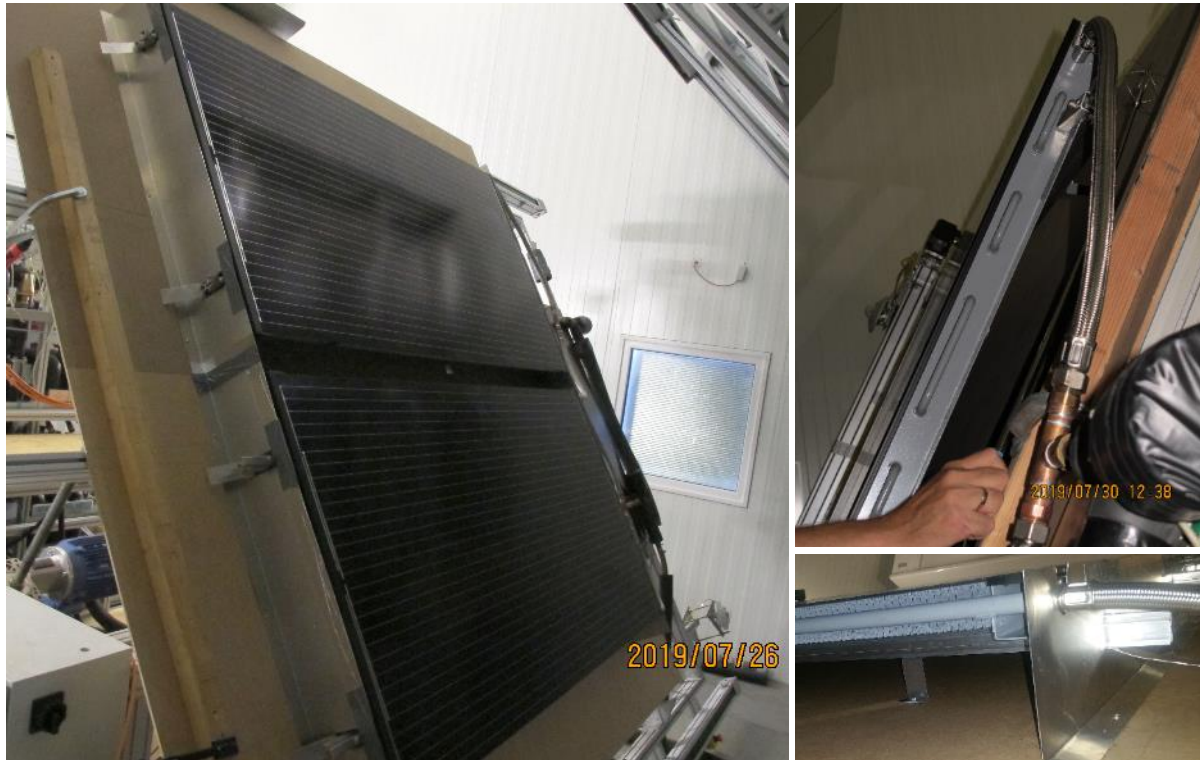
Abbildung 23: Versuchsaufbau in Parallel-Dachmontage mit verstellbarem Neigungswinkel und Dachabstand, bestehend aus zwei Kollektoren übereinander und geschlossener Rückwand als Dachhaut. Übersichtsbild (links) und Ansicht Dachzwischenraum von unten (rechts unten) mit seitlichen Begrenzungsblechen zur Nachbildung der Verhältnisse im Feld (Messung Wärmeübertragungsvermögen). Strömungsmessung im Luftspalt (rechts oben) ohne seitliche Begrenzungsbleche.
