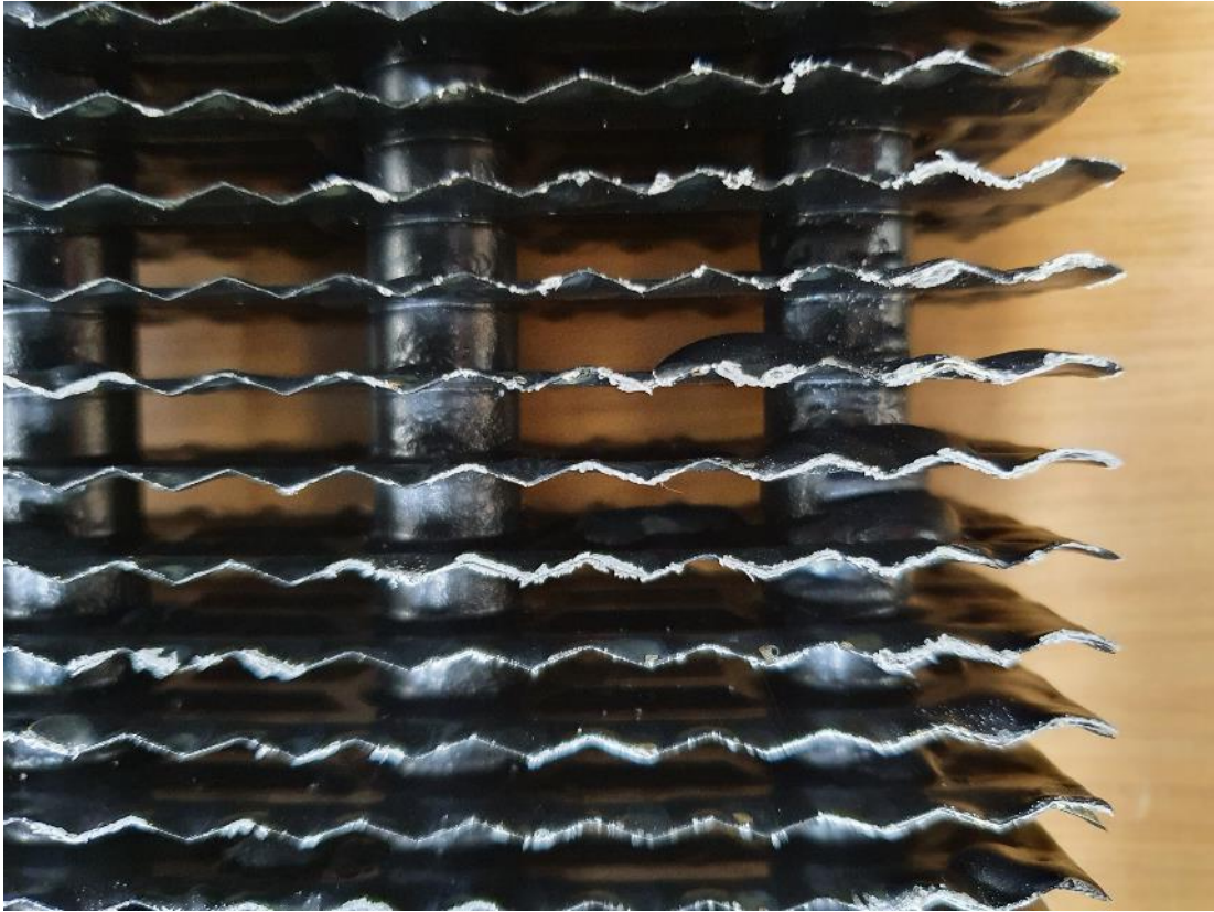
Abbildung 20: Draufsicht mit Rohrleitungen und Lamellen Probe 2
