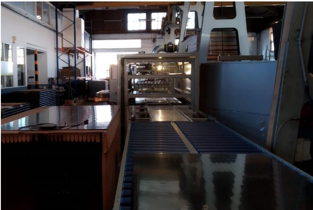
Abbildung 11: Fertigungsstraße für SOLINK-Kollektoren: Die PV-Module (vorne im Bild) durchlaufen einen Roboter, in dem der Kleber nach programmiertem Muster aufgetragen wird. Danach wird der Lamellen-Wärmeübertrager aufgesetzt.
