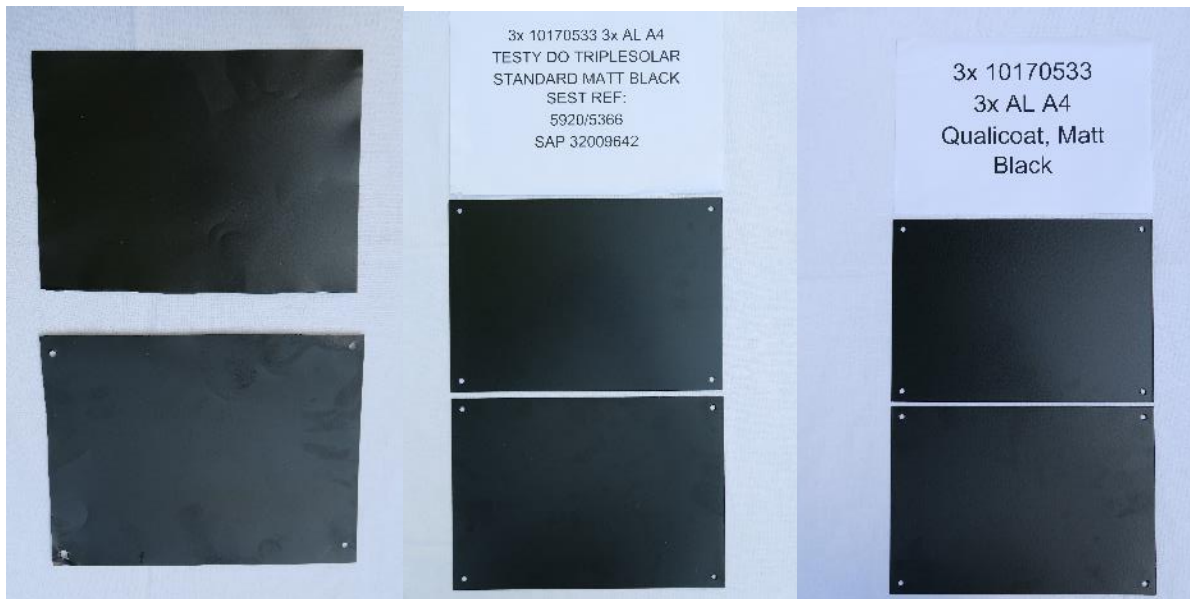
Abbildung 14: Photographischer Vergleich der 3 Proben im Neuzustand (oben) und nach der UV-Belastung (unten) der 3 Proben (Probe 1: links, Probe 2: Mitte, Probe 3: rechts)
