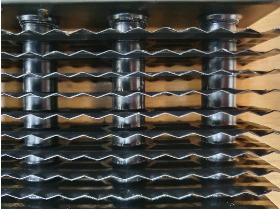
Abbildung 21: Draufsicht mit Rohrleitungen und Lamellen Probe 3
