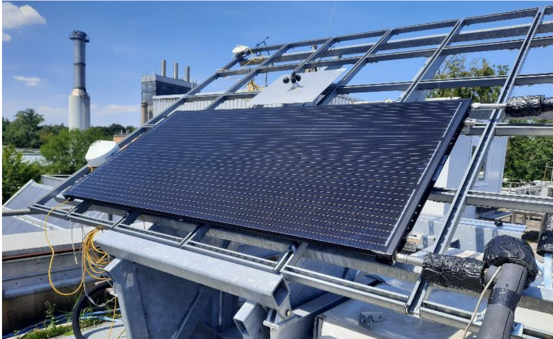
Abbildung 12: Der SOLINK PVT-Kollektor mit 35 mm Lamellen auf dem Außenprüfstand des IGTE der Universität Stuttgart.
