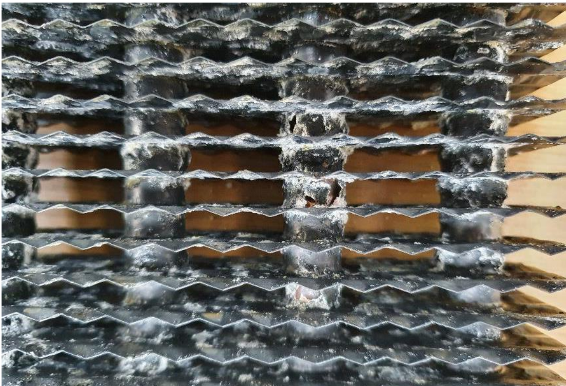
Abbildung 19: Draufsicht mit Rohrleitungen und Lamellen Probe 1
