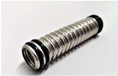
Abbildung 28: Kollektorverbinder mit je 2 O-Ringen auf beiden Seiten. Die Wellenform ermöglicht, Versatz zwischen Kollektoren auszugleichen; eine Längenkompensation ist dagegen nicht nötig, da der Abstand der Sammlerrohre fixiert ist.
