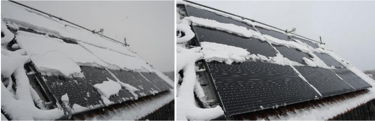
Abbildung 43: Schneeabrutschverhalten am PVT-Kollektorfeld mit Lochblechen (Konfiguration C2).
