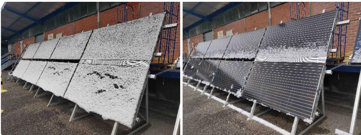
Abbildung 34: Vergleich Schneeabrutschen mit und ohne Lochblech zwischen den Kollektoren (Lochblech hier noch unbeschichtetes Aluminium): praktisch gleiches, d. h. ungestörtes Abrutschverhalten mit und ohne Blech.
