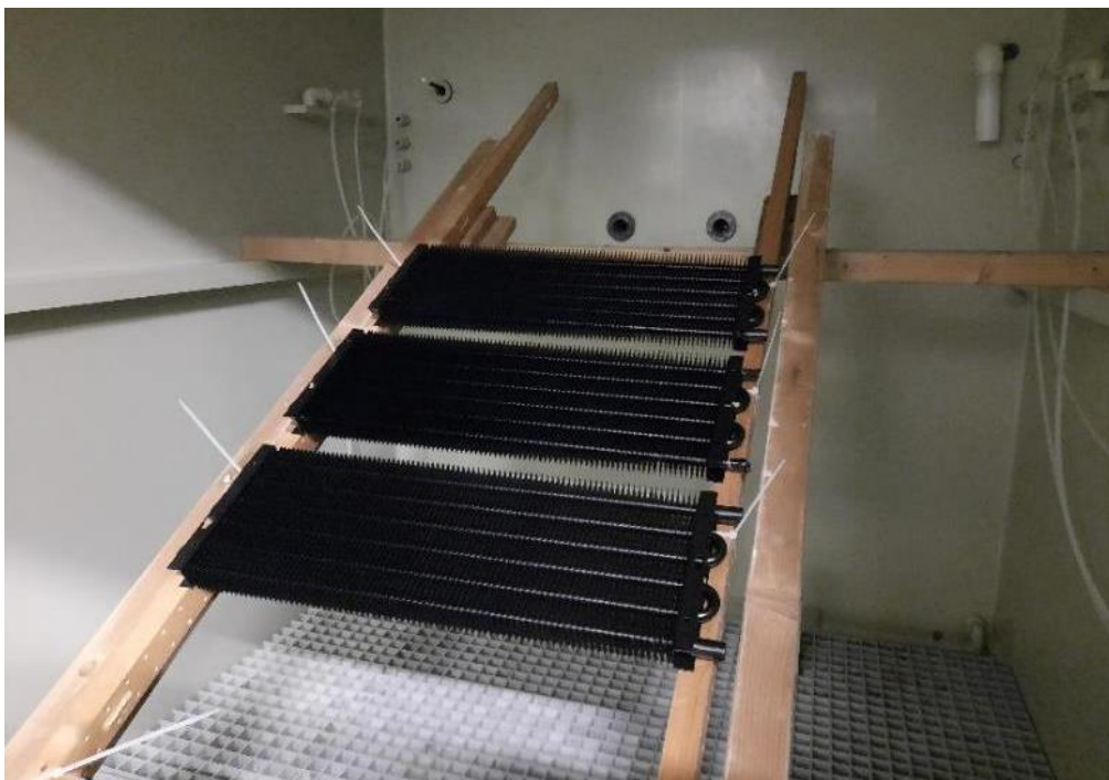
Abbildung 15: Die untersuchten Wärmeübertrager in der Salzsprühnebelkammer vor Beginn der Prüfung.
