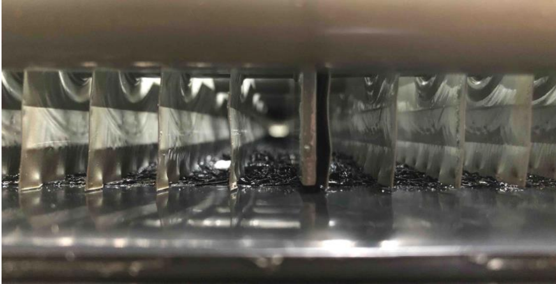
Abbildung 10: Wärmeübertragerlamellen mit ausgewähltem Kleber auf Rückseite des PV-Moduls (unten) geklebt.
