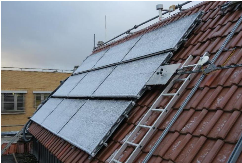
Abbildung 36: Kollektorfeld aus 3 x 3 PVT-Modulen (ohne Lochblech-Abdeckungen, Konfiguration B) und Messgeräte für Umgebungstemperatur, Windgeschwindigkeit und Bestrahlungsstärke.
