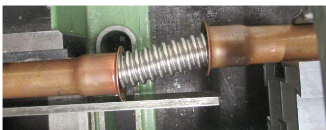
Abbildung 30: Kollektorverbinder im Dauertest bei extremem Versatz
