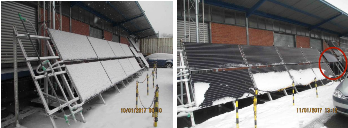
Abbildung 13: links: schneebedeckte PVT-Kollektoren bei Schneefall, rechts: Schnee rutscht auf ungekühlten PV-Modulen (rechts) schneller ab
