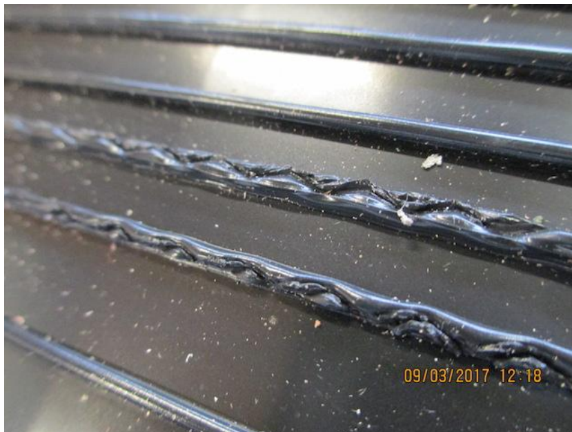
Abbildung 20: Klebelinien des untersuchten PVT-Kollektors: nur teilweise waren diese an der richtigen Position und in Kontakt mit den Wärmeübertragerlamellen
