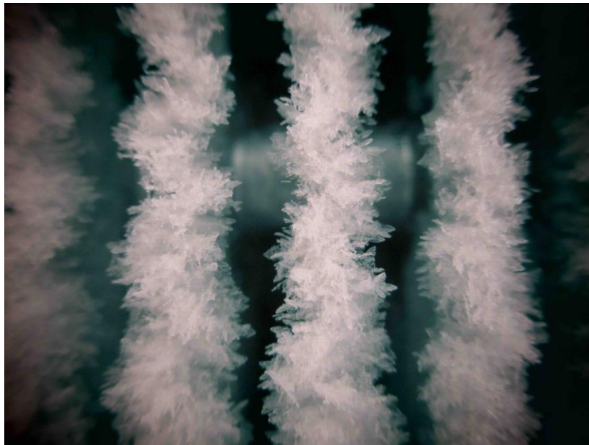
Abbildung 10: Detailaufnahme Eisbildung: in Richtung PV-Modul ist Eisbildung wesentlich schwächer
