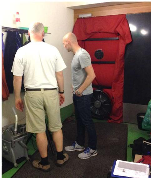
**Abb. 22:** Eingebaute Blower Door in der Außentür des Anlieferungsbereichs während der Unterdruckmessung zur Leckagesuche am 04. Mai 2016.
