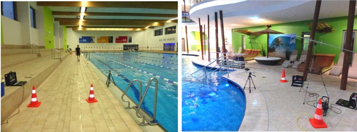
**Abb. 57: Luftprobenahme mit Ansaugpumpen im Bambados in der Sporthalle mit 50 m Bahn (links) und in der Freizeithalle (rechts)**
