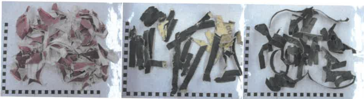
Abbildung 8: Zerkleinerte Stanzreste und Schleifmittel mit Papier- und Gewebeunterlage der Korngrößenklasse 36-60 mm.
