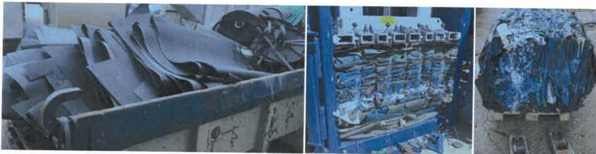
Abbildung 5: Pressversuche: Aufgabematerial (links), Kammerpressvorgang (Mitte) und gepresster Ballen (rechts).
