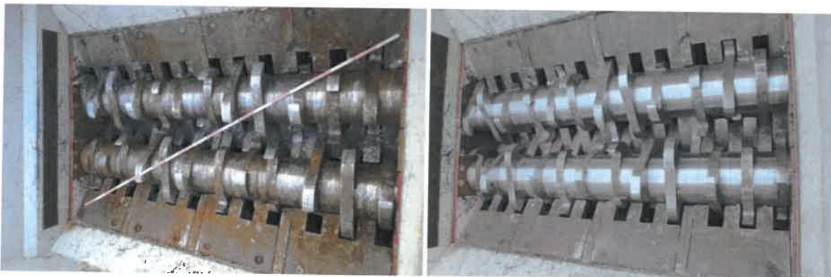
Abbildung 13: Kammwalzenzerkleinerer vor und nach den Zerkleinerungsversuchen in Kampagne 2.
