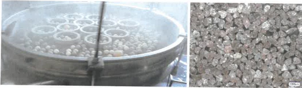
Abbildung 30: Siebung bei 400 µm auf einem Taumelsieb und Korund-Schleifkornkonzentrat im Siebüberlauf.
