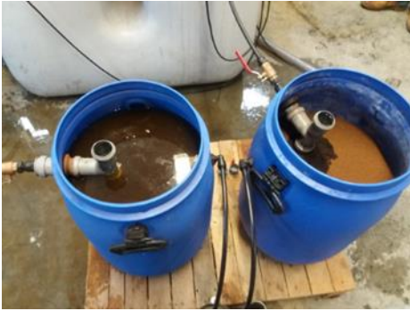
Abbildung 6: Foto der Kartusche K002 (links) mit Granulat
