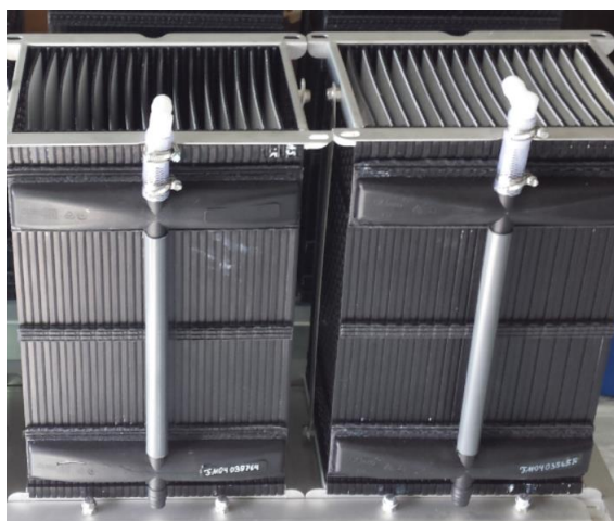
Abbildung 3-6: Detailaufnahmen SLIM-Membranfilter und Filtratablaufleitung mit PN-Stelle
