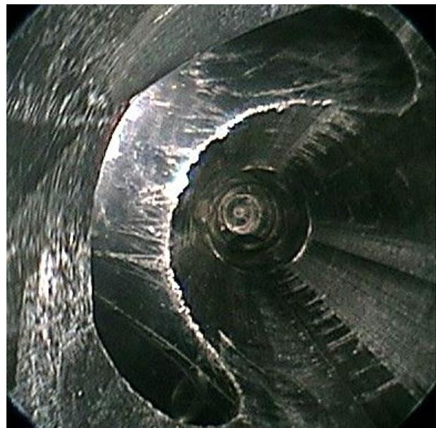
**Abbildung 2-37:** Ölkanal eines Zylinderkopfgehäuses (mit Ultraschall-Sonotroden entgratet)
