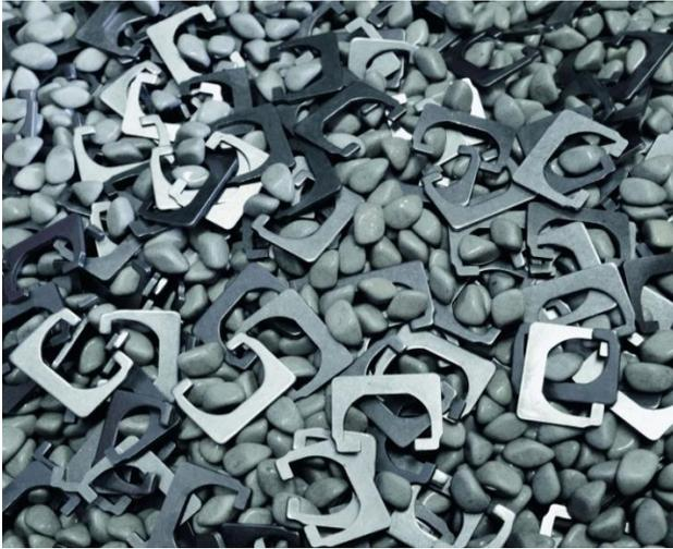
**Abbildung 1-6:** Gleitschleifvorgang
