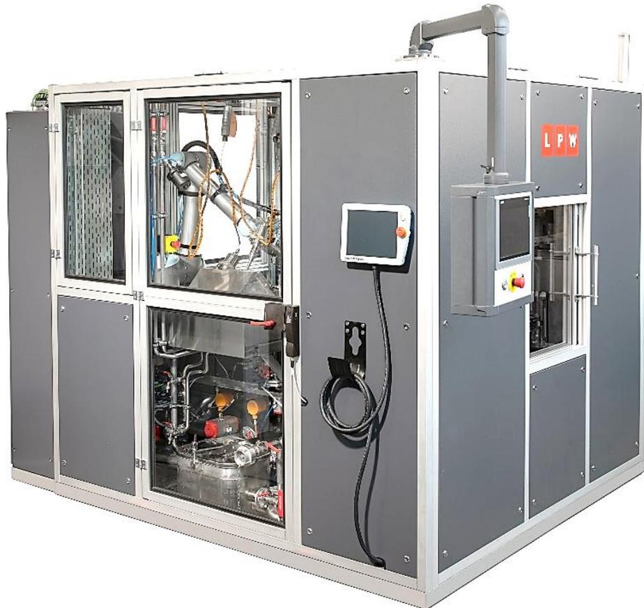
Abbildung 2-47: **Prototyp der Robotergestützten Ultraschall-Entgratanlage**
