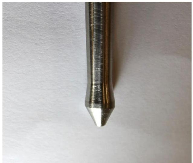
**Abbildung 2-8:** Sonotrodenkopf (2) (Sonderform)
