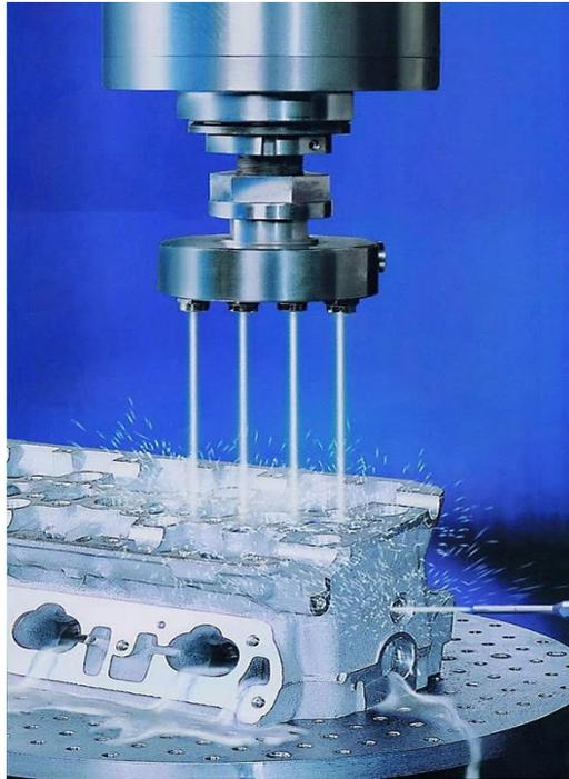
**Abbildung 1-17:** Hochdruckwasserstrahlen an Zylinderkopf (Schulz 2013)
