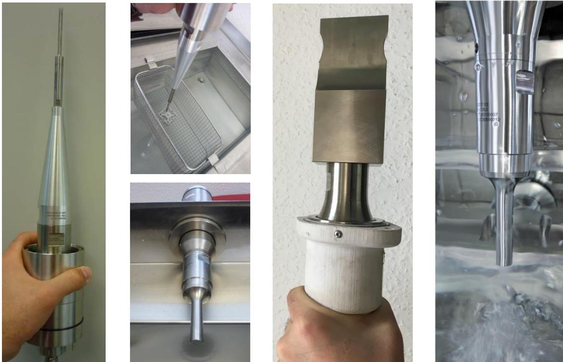
Abbildung 2-50: **Unterschiedliche Sonotrode**
