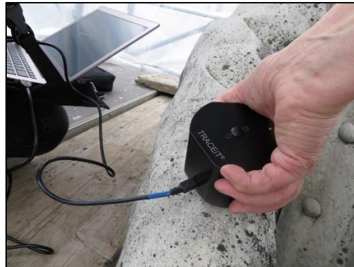
Abb 10: Messung der Rauheit einer Marmoroberfläche durch Aufsetzen des Messkopfes (Foto: Irene Köhler 2016)
