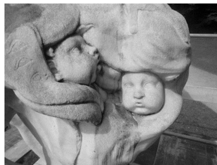
Abbildung 7: Endstadium der Rauheit bei Sterzinger Marmor. Die Einzelkristalle treten markant hervor.
