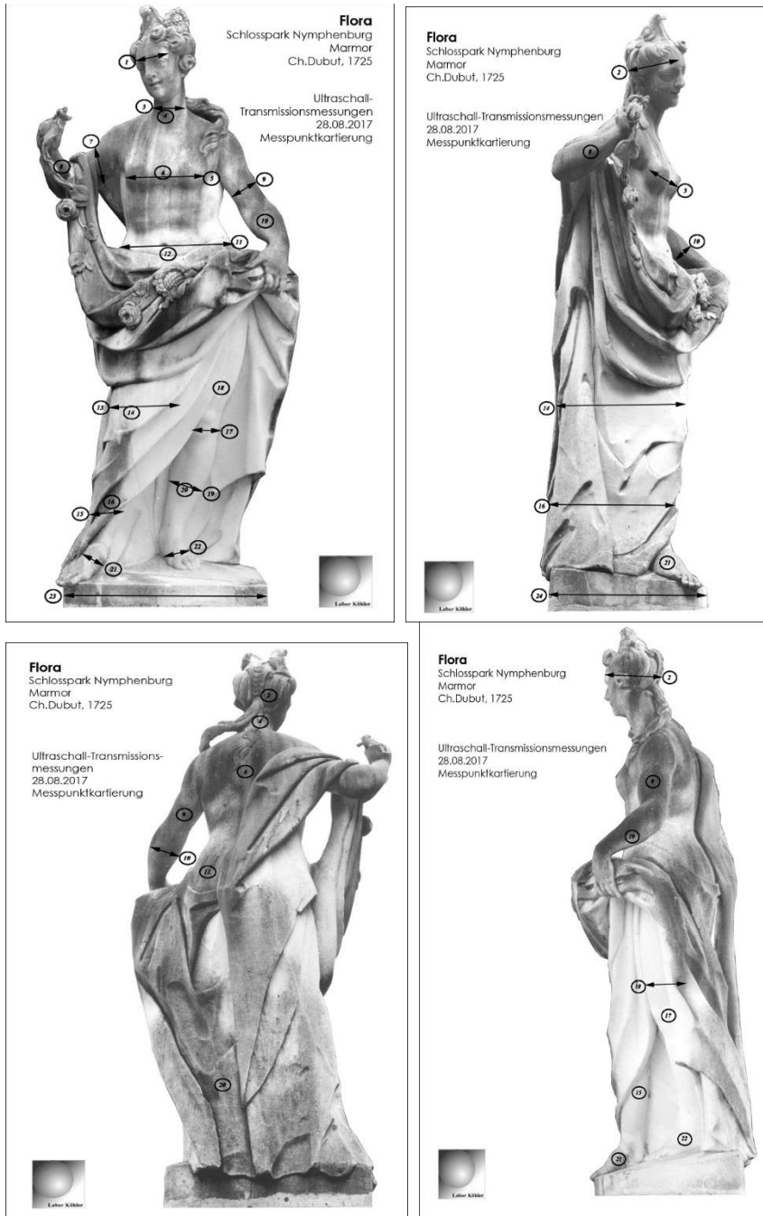
Abbildung 6: Kartierung der Ultraschallmesspunkte an der Skulptur „Flora“ im Schlosspark Nymphenburg. Die Zusammenstellung der Messungen vermittelt einen Eindruck vom Zustand der einzelnen Skulpturen.
