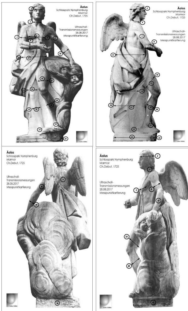
Abbildung 5: Kartierung der Ultraschallmesspunkte an der Skulptur „Äolus“ im Schlosspark Nymphenburg
