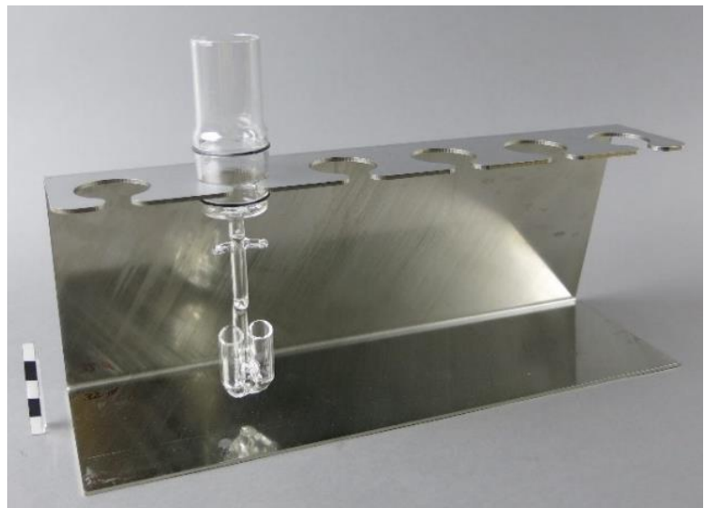
Abb. 35: Glaseinsatz des Reaktionsbehälters im Edelstahlständer
