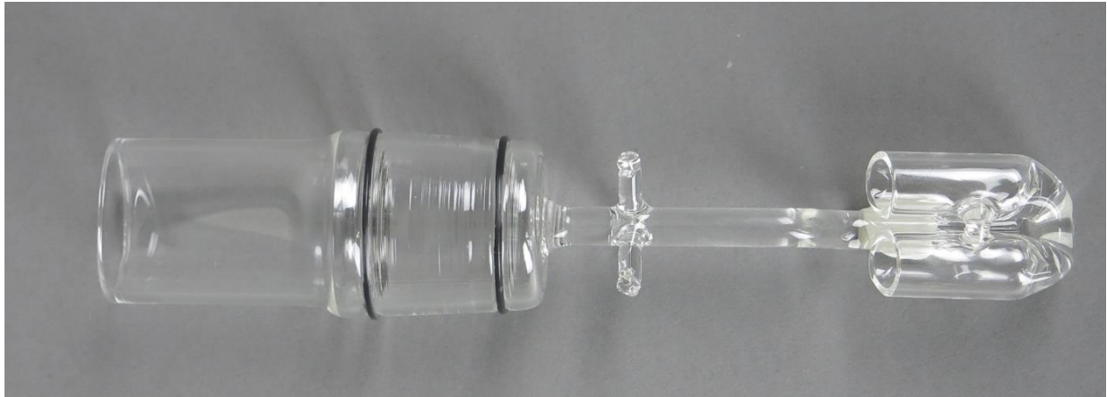
Abb. 11: MAT-CH Reaktionsbehälter, Einsatz mit Dichtungen (li), geschlitzten Haken (mi) und Glasreservoirs (re)
