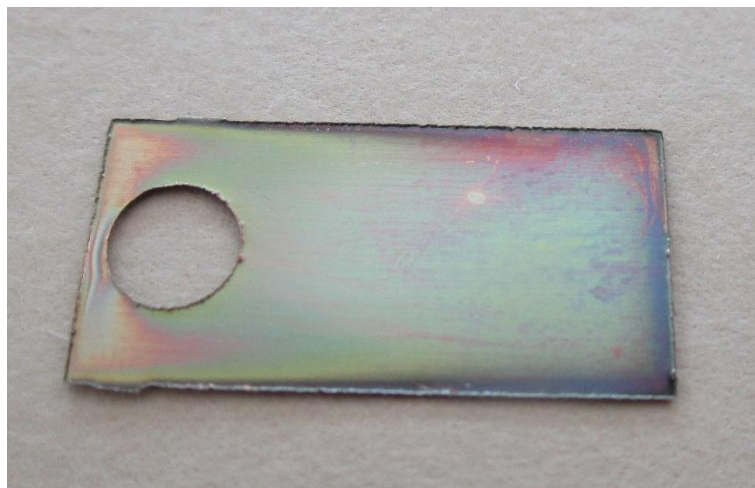
Abb.27: Stark oxidiertes Cu-Indikator nach der Reinigung im Niederdruckplasma mit einem Argon / Wasserstoff-Gemisch bei 150 Watt und 0,3 bar
