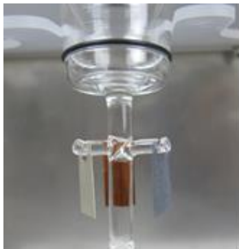
Abb.12: Detail Einsatz, eingehängte Indikatoren
