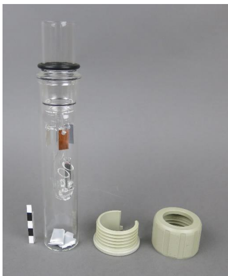
Abb.14: Bestückter MAT-CH Reaktionsbehälter, offen
