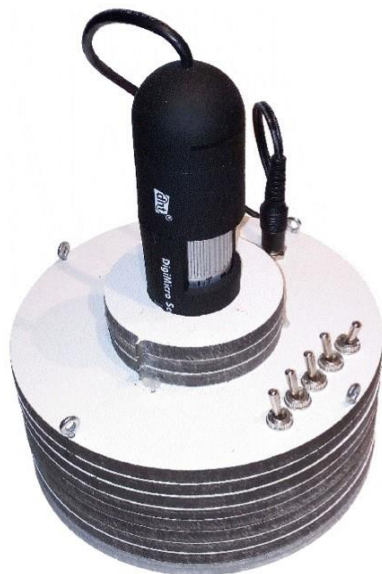
Abb. 38: Portable Fotostation mit Mikroskopkamera
