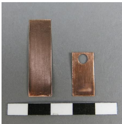
Abb.16: Format der Cu-Indikatoren Oddy-Test (li) und MAT-CH (re)
