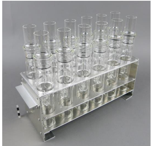
Abb. 37: Aluminiumständer für Reaktionsbehälter
