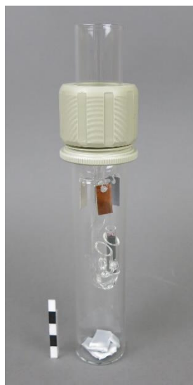
Abb.15: Bestückter MAT-CH Reaktionsbehälter, verschlossen
