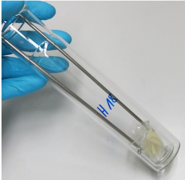
Abb. 36: Einsetzen des Tiegels mit Testmaterial in den Reaktions- Behälter
