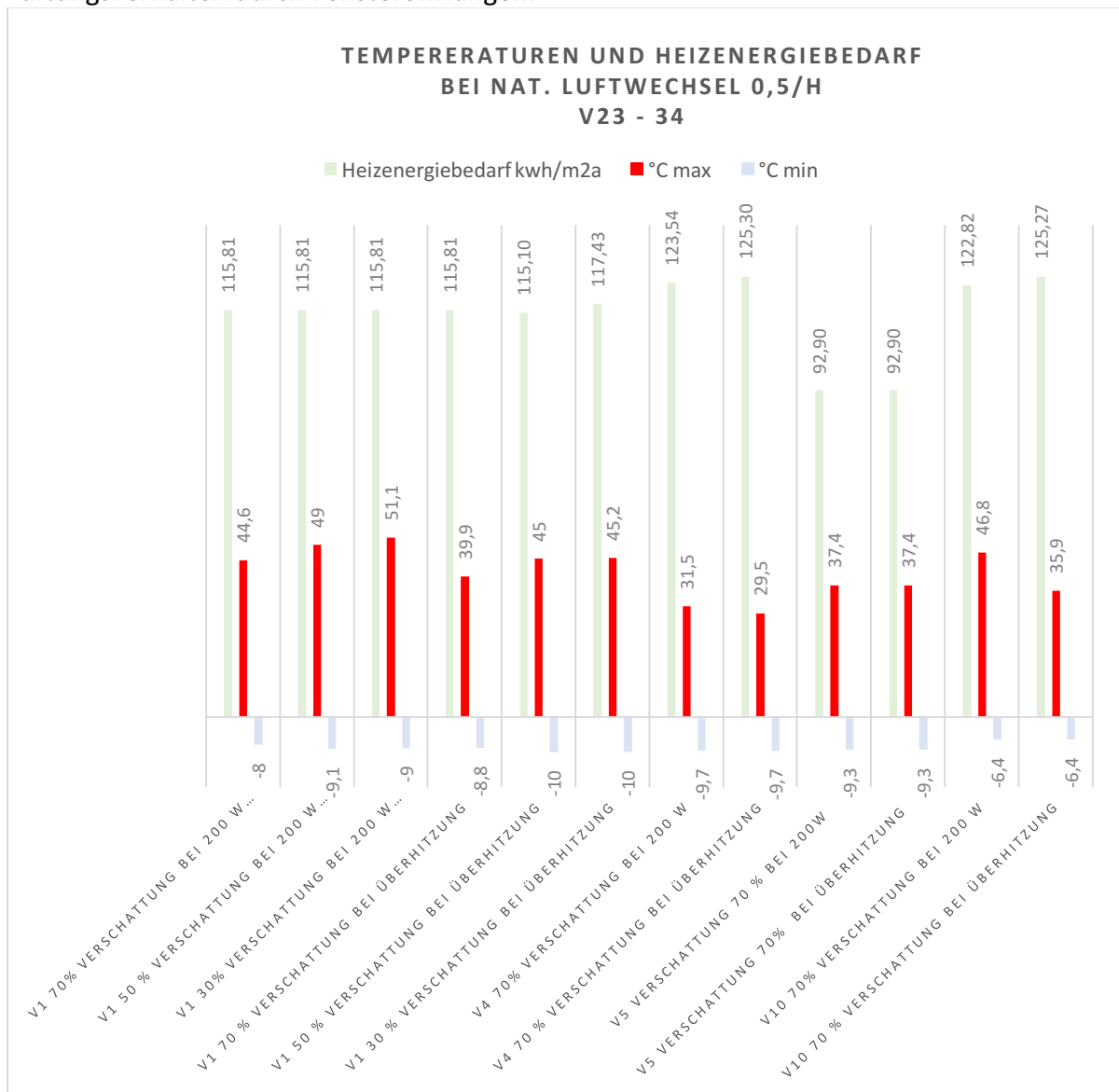
Diagramm 6 Ergebnisse V23-34 – Untersuchungen von natürlichem Luftwechsel 0,5/h
