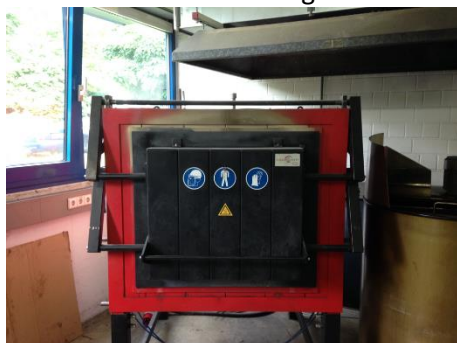
Abbildung 1: Härteofen 29 kW, Quelle: Aufnahme PATAVO
