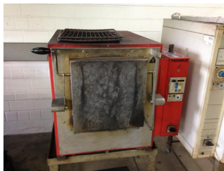
Abbildung 2: Härteofen 5,8 kW, Quelle: Aufnahme PATAVO
