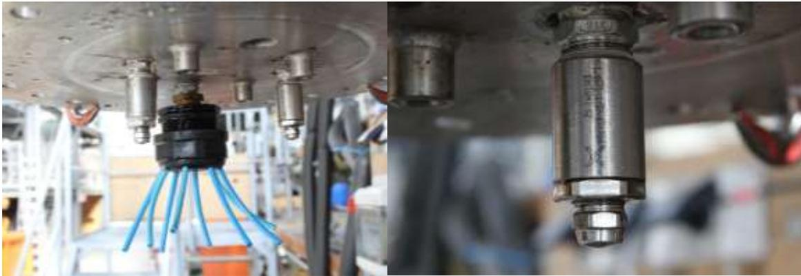
**Abbildung 8: installierte Vorrichtungen zur Gasverteilung und Flüssigkeitsverteilung; links: Gasverteiler sowie 2 Düsen zur Flüssigkeitsverteilung am Reaktorkopf, rechts: Düse (Nahaufnahme)**
