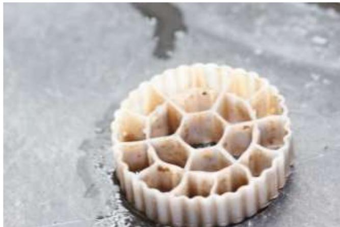
**Abbildung 9: angeimpfter Aufwuchskörper im optimierten Rieselbettsystem (RB4)**
