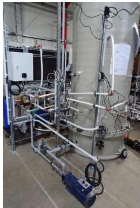
**Abbildung 45: Testapparatur zur Beobachtung und Beurteilung der Prozesskinetik im Rieselbett (im Bau)**
