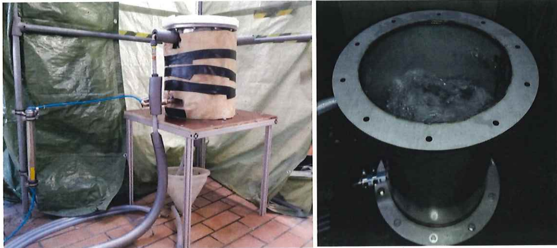
Abbildung 5: Foto des Versuchsaufbaus der invers betriebenen Blasensäule (links) und der offenen Blasensäule im Betrieb mit voll ausgebildeter Blasenschicht (rechts)
