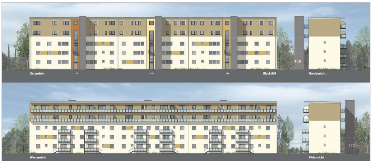
Abbildung 113 Ansichten einer Wohnzeile mit Aufstockung
