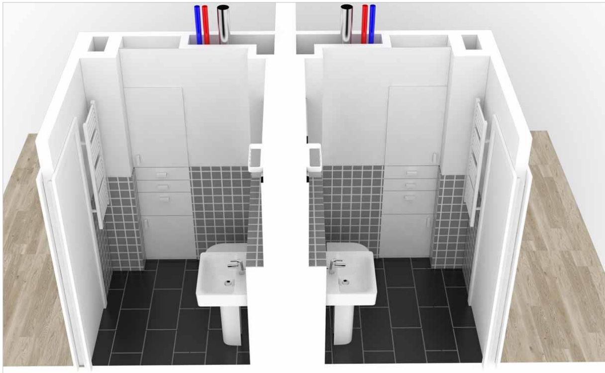
Abbildung 102 Schema des vorgefertigten Bad-Blocks [HOWOGE-JAHN 2017]
