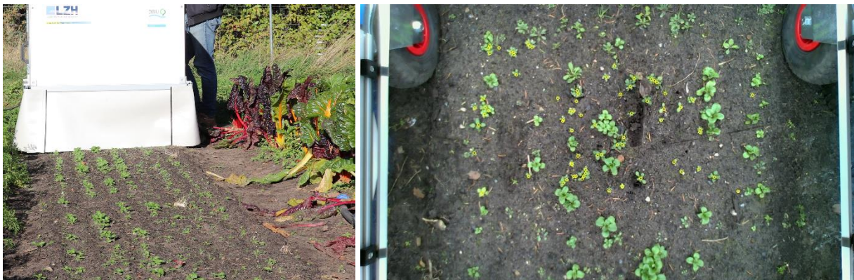
Abbildung 17 - Felddemonstrator bei der Unkrautbehandlung in einer Feldsalat-Kultur (links). Aufnahme des Arbeitsbereichs inklusive durchgeführter Markierung der Unkräuter (rechts).
