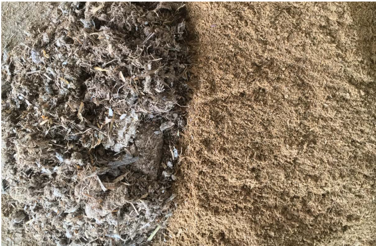
Abbildung 3-13: Hähnchenmist unbehandelt (links) und nach der Vermischung mit Branntkalk im Umwandler (rechts)
