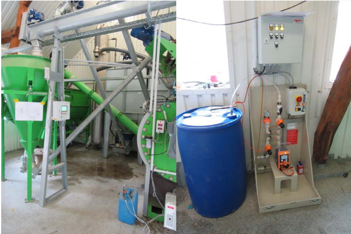
Abbildung 3-8: Schwefelsäurewäscher an der halbtechnischen Versuchsanlage (linkes Bild im Hintergrund) und Dosierstation für Schwefelsäure (rechtes Bild)
