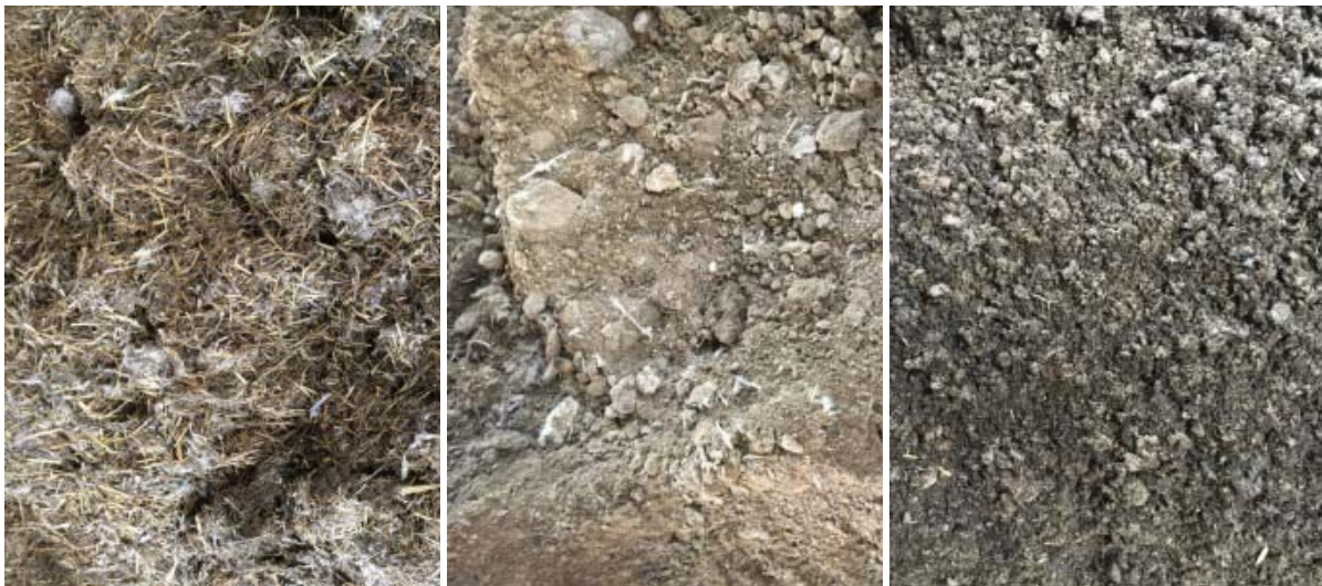
Abbildung 3-14: Die drei Substrate der abschließenden Versuchsreihe: Putenmist mit Langstroh als Einstreu (links), Putenmist mit Strohpellets als Einstreu (Mitte) und separierter Gärrest (rechts)
