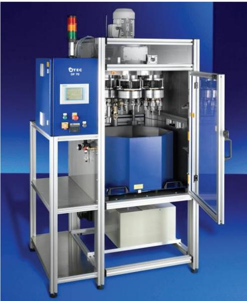
Bild 7: OTEK Schleppscheifanlage für Zerspanwerkzeuge (Bild [GEG09])
