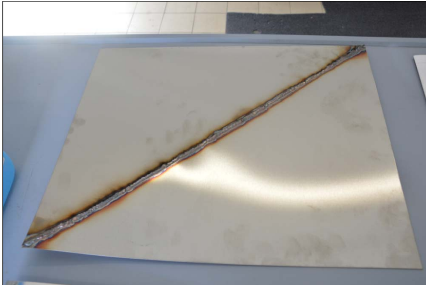
Abbildung 27: Musterplatte aus 2 Werkstoffen mit Schweißnaht vor Färbeprozess (Fa. Henkel).
