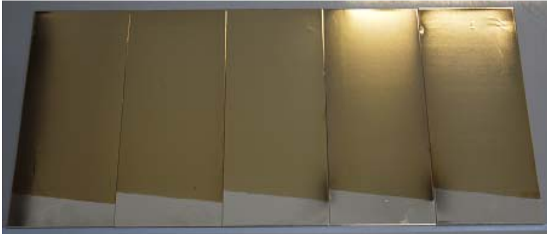
Abbildung 15: Versuchsserie 3 _ 5 Probenbleche gleichzeitig, parallel gefärbt, Vorderseite.
