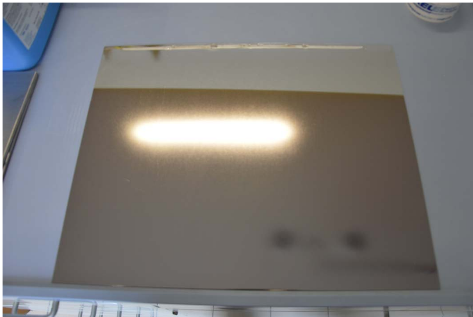
Abbildung 28: Musterplatte nach 20 min Färben und 1 % Fe im Elektrolyten (Fa. Henkel).
