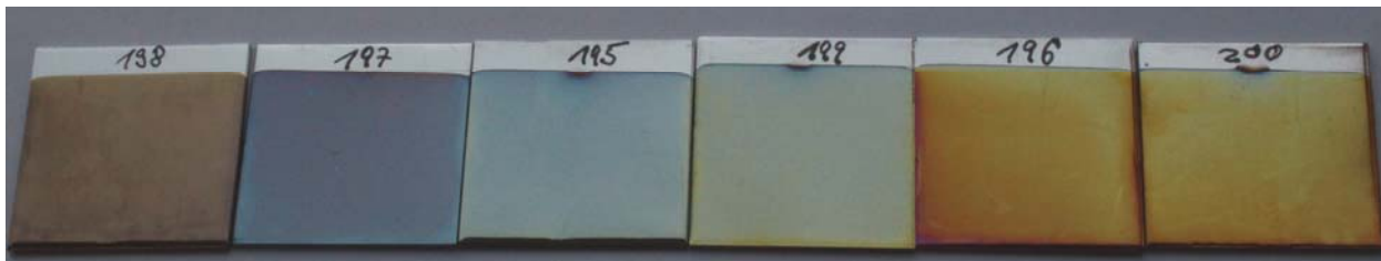
Abbildung 6: Farbtöne nach 20, 30, 40, 50, 60 und 60 min Anodisation mit den o.g. Prozessparametern.
