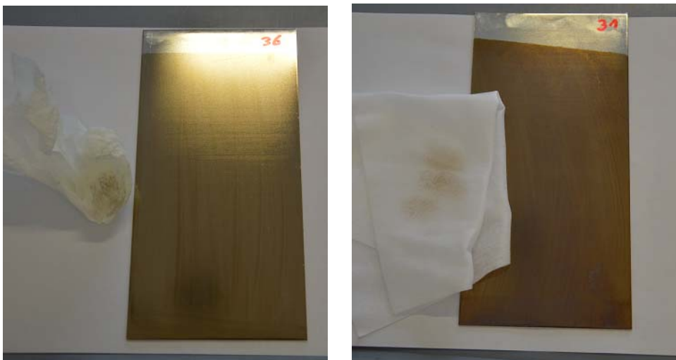
Abbildung 17: Links: Abrieb mit Küchenrolle + Deionat; Rechts: TX409 Absorbond Wipers + Deionat.
