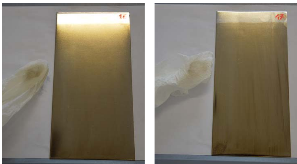
Abbildung 18: Links: Abrieb mit Küchenrolle + Aceton; Rechts: Abrieb mit Küchenrolle + 2-Propanol.
