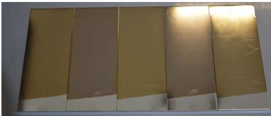
Abbildung 24: Vergleich von 5 gleichzeitig eingefärbten Edelstahlblechen – Rückseite (Fa. Henkel).
