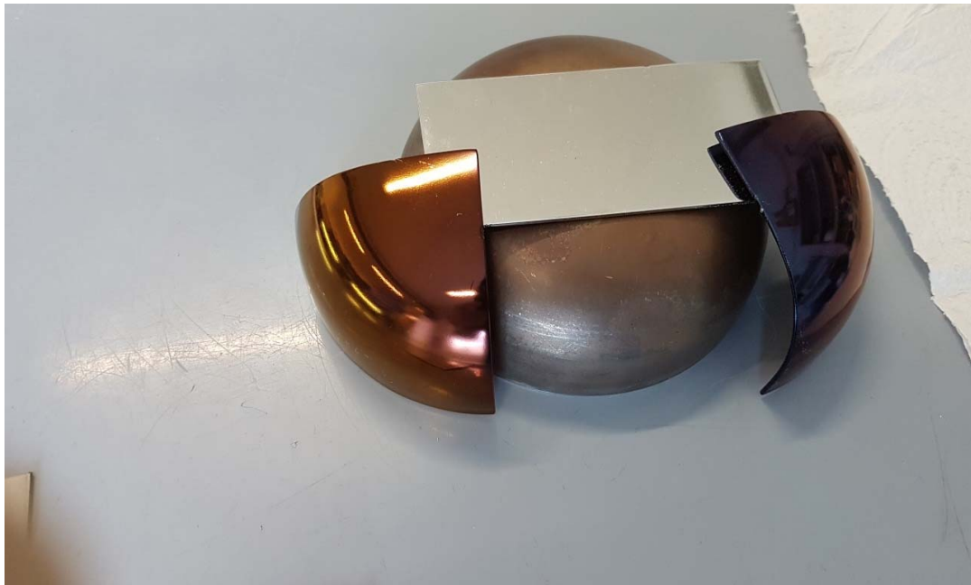
Abbildung 31: Betrachtungstest von Proben: Eingefärbte (50 min) 1/4-Stück-Halbschal (Fa. Henkel).
