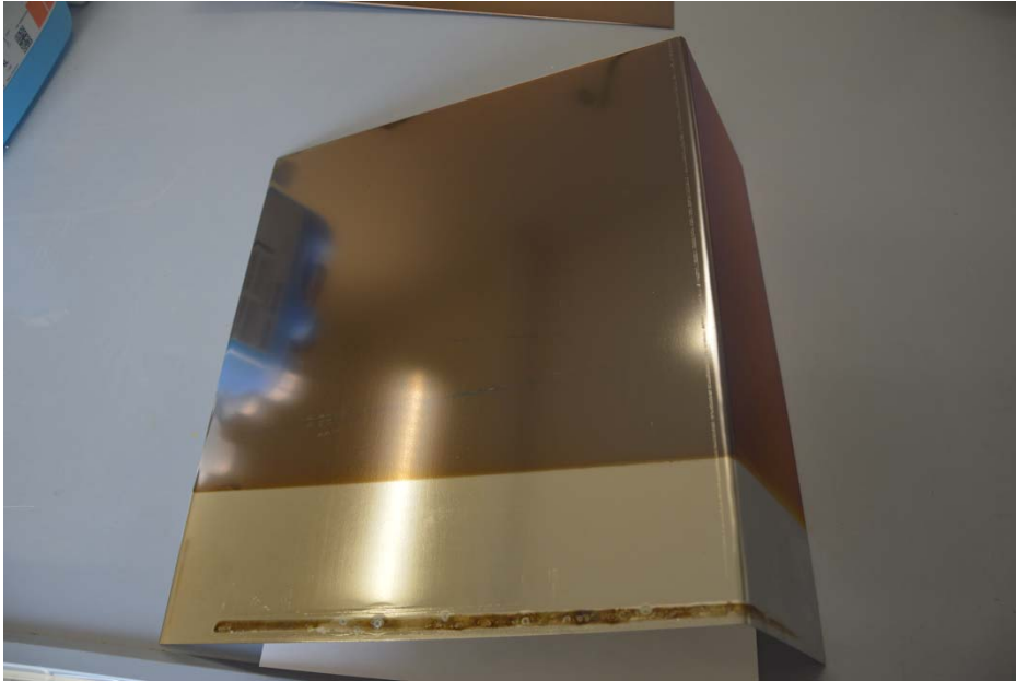
Abbildung 19: Ansicht geknickte Musterplatte nach 20 min Färben mit Spannungspulsen (Fa. Henkel).
