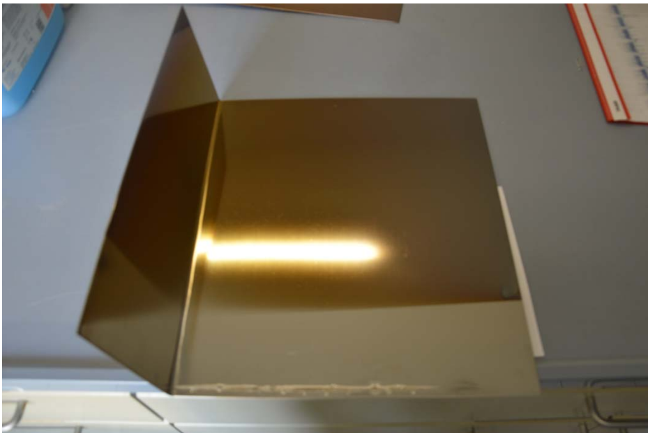
Abbildung 20: Ansicht geknickte Musterplatte nach 20 min Färben mit Spannungspulsen (Fa. Henkel).
