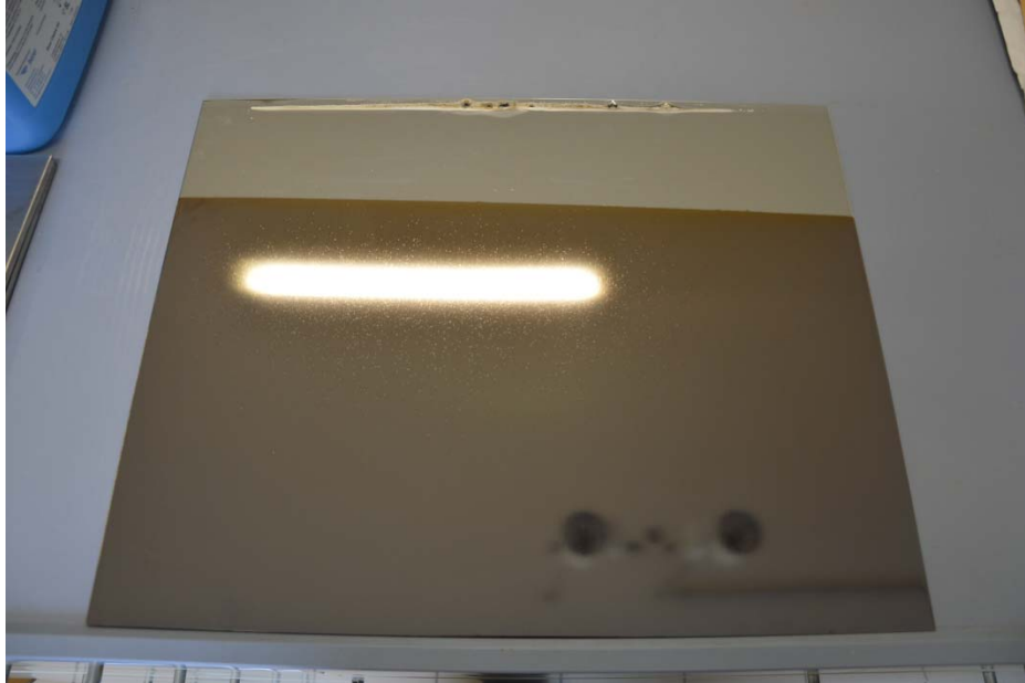
Abbildung 27: Musterplatte nach 20 min Färben und 0,75 % Fe im Elektrolyten (Fa. Henkel).
