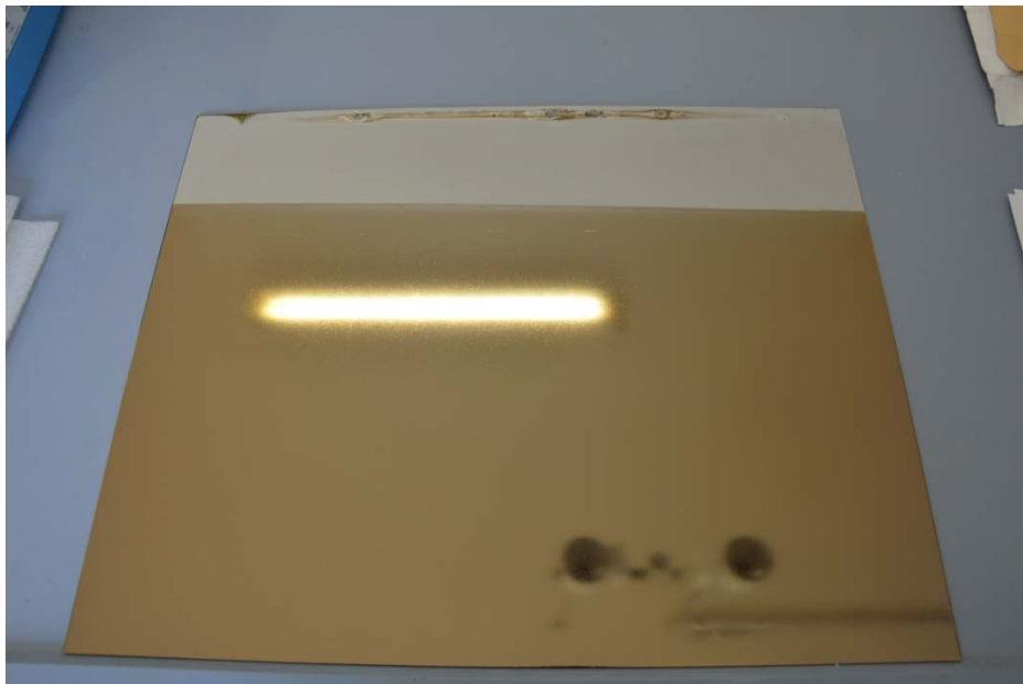
Abbildung 26: Musterplatte nach 20 min Färben und 0,5 % Fe im Elektrolyten (Fa. Henkel).
