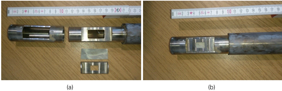
Abbildung 2.3: Fotografie der PartikelGitterNetzSonde im demontierten (a) und montierten (b) Zustand
