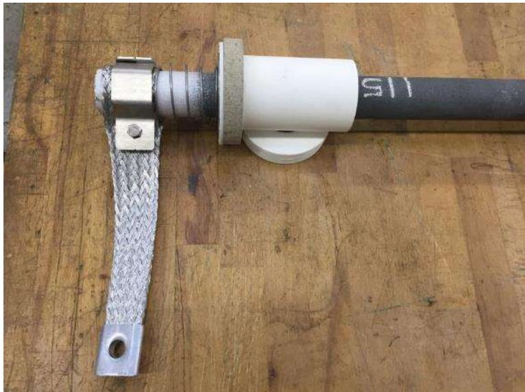
Abbildung 26 - Heizelement mit Anschlusszubehör
