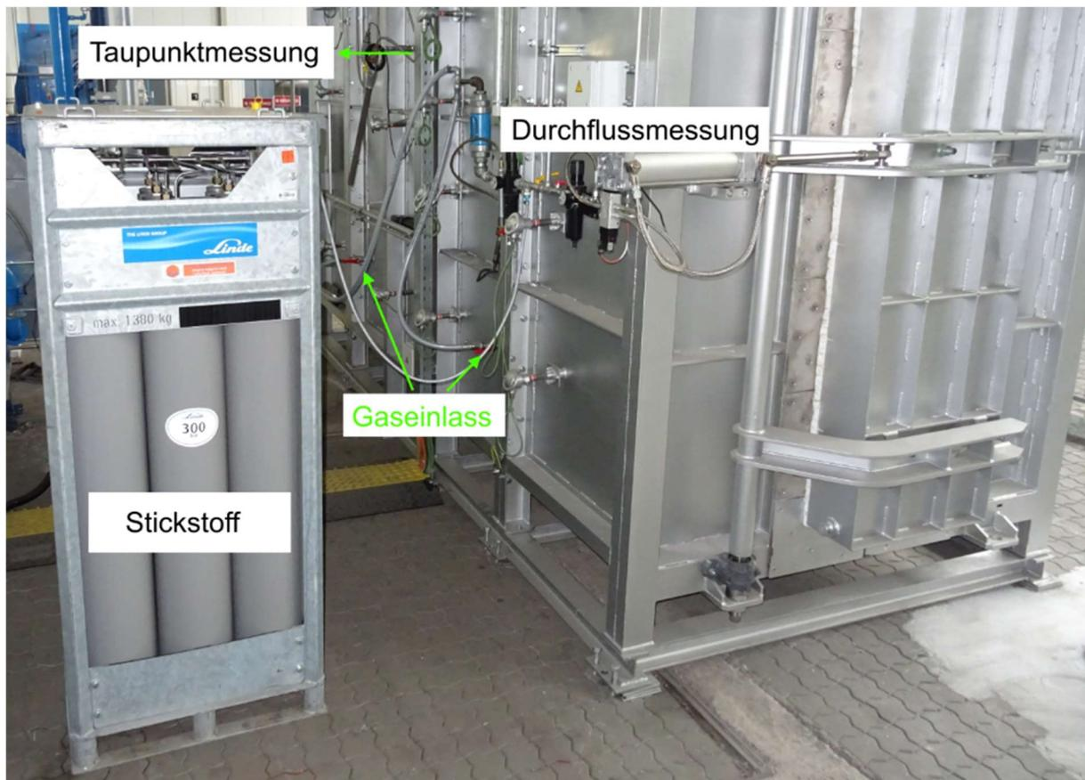
Abbildung 30 - Versuchsaufbau zur Taupunktregulierung der Ofenanlage
