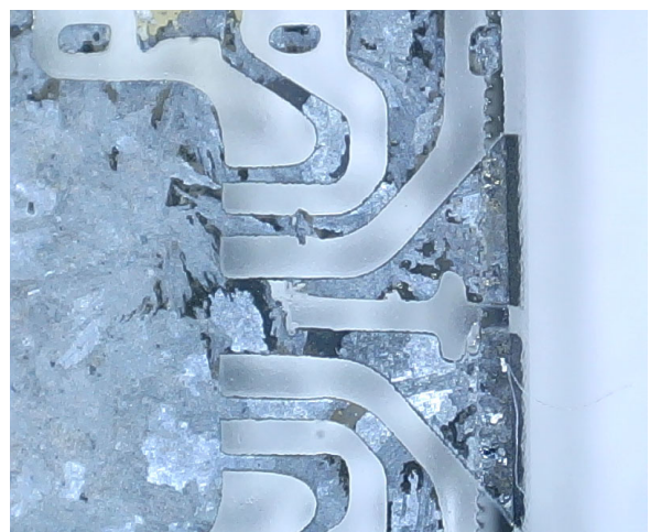
Abbildung 25: Ausschnitt mit dem Digitalmikroskop. Ein Auslaufen in die vormals nicht aufgedampften Bereiche ist nicht erkennbar.
