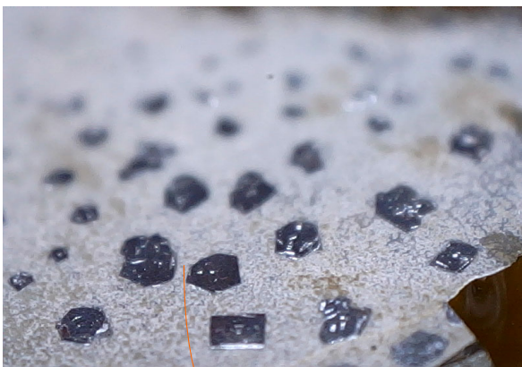
Abbildung 4: Probe6 mit etwa 0.5 mm großen Silizium-Kristalliten.
