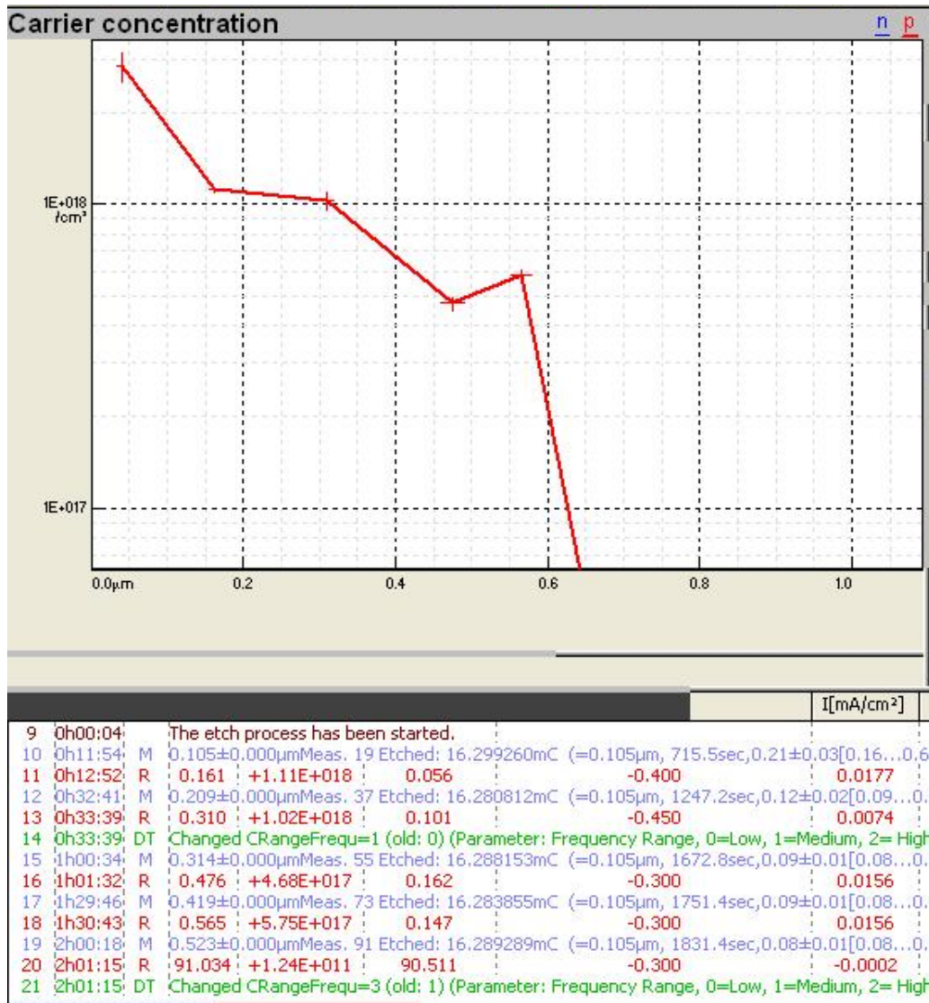
Abbildung 19: ECV Messung im großen Ätzkrater. Die Dotierung liegt im Bereich von 10^{18}\text{cm}^{-3}
