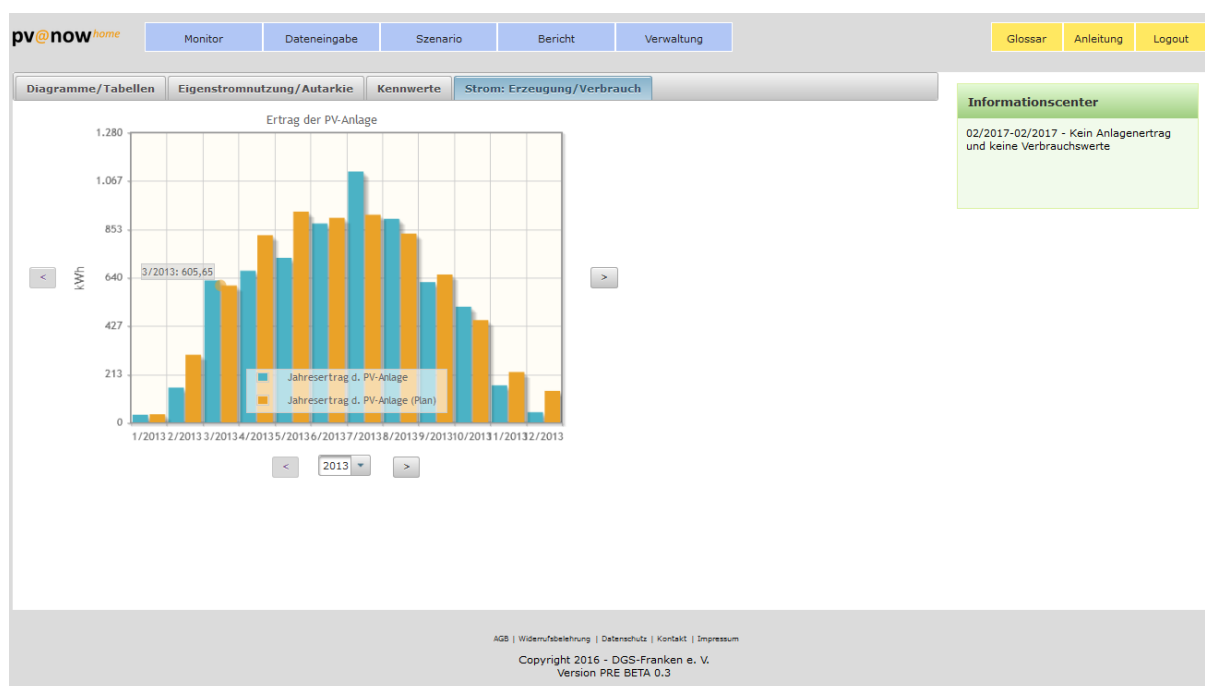
Abbildung 4: ECO-PV-Monitor, hier Erträge der PV-Anlage
