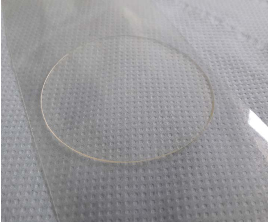
Abbildung 57: Mit zweiter Folie abgedeckter, maschinell erstellter Druckling
