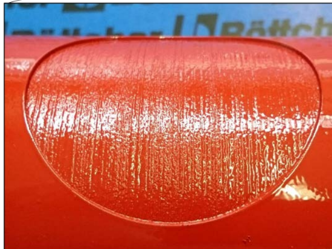
Abbildung 39: Ausgelaserte Form einer silikonbasierten Walze
