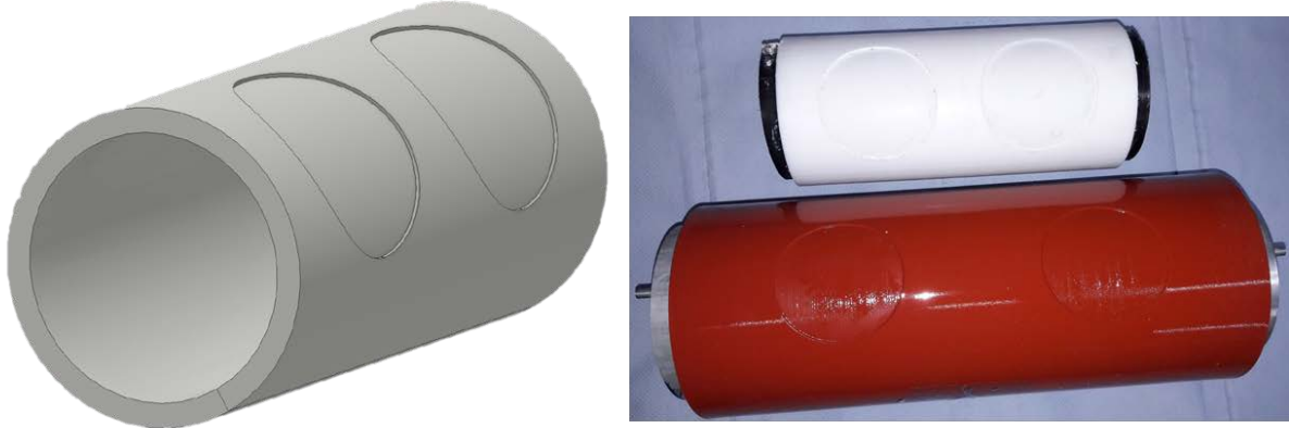
Abbildung 38: Formwalze CAD (links), gefertigte Ausführungen PTFE (rechts oben), Silikon (rechts unten)
