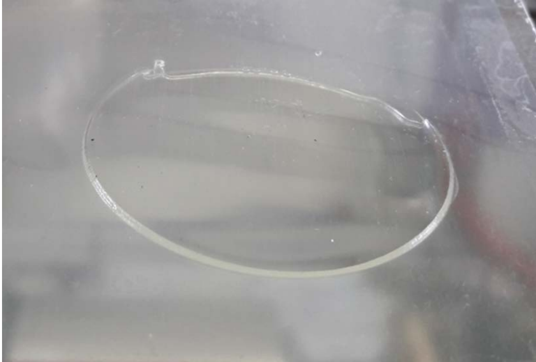
Abbildung 54: Druckling aus nicht ausgefüllter Form
