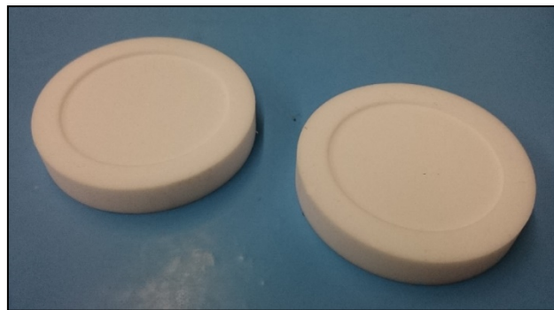
Abbildung 24: Druckformen zur Handapplikation aus PTFE
