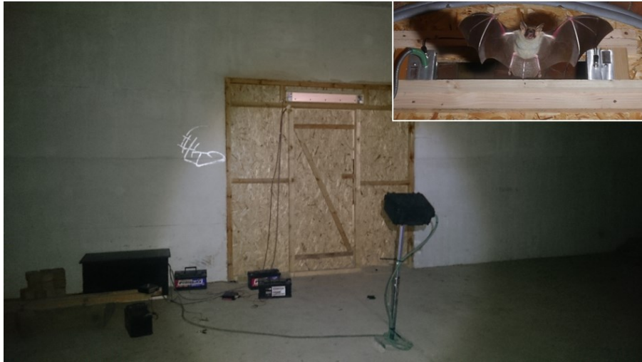
Abb. 4: Lichtschranke mit Fotofalle in einem umgebauten Bunker. Oben rechts: Großes Mausohr beim Einflug durch eine Lichtschranke.
