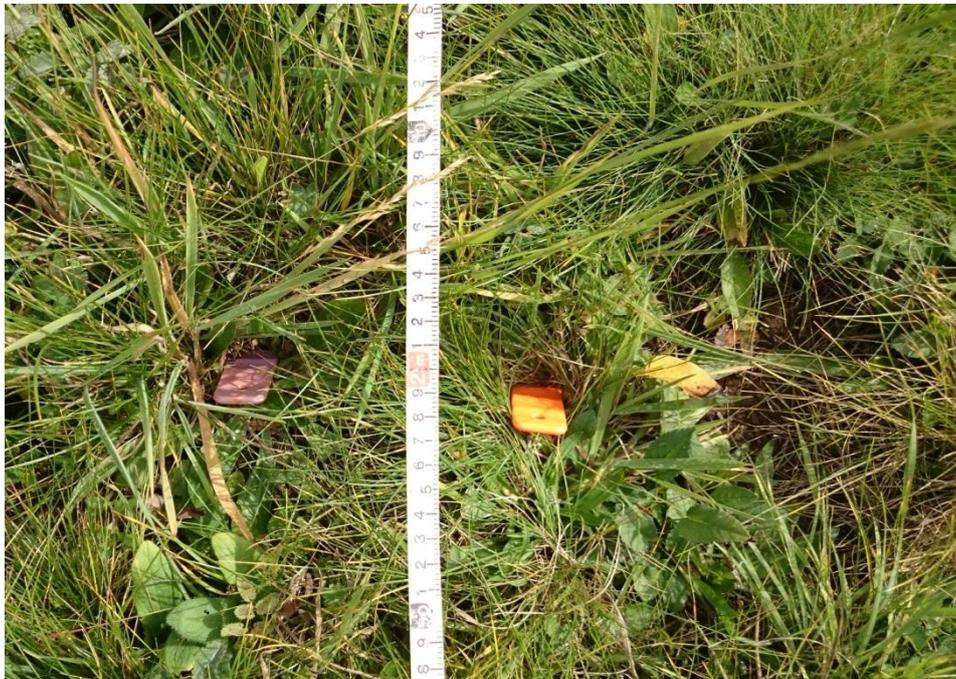
Abbildung 3: PRS-Proben auf einem der Plots links (violett) mit negativ geladener Membran zur Adsorption von Kationen und rechts (orange) mit positiver Membran zur Adsorption von Anionen (Foto: K. Ludewig).
