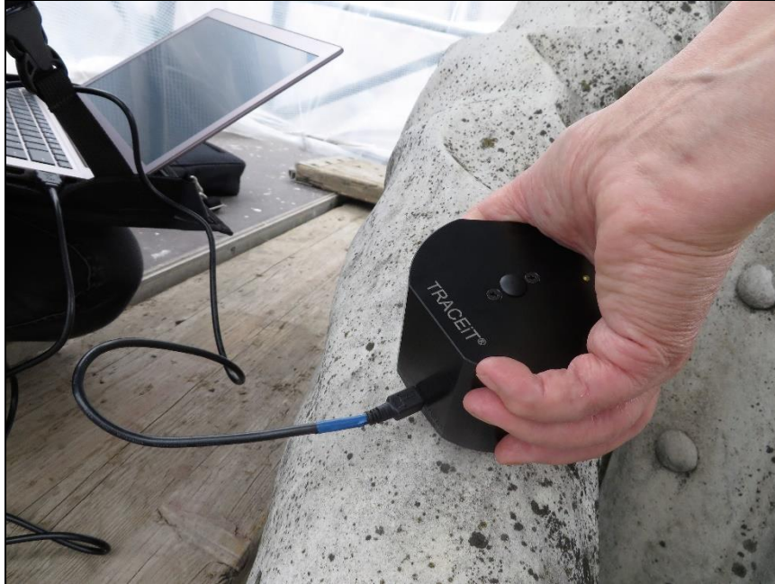
Abbildung 26: Messung der Rauheit einer Marmoroberfläche durch Aufsetzen des Messkopfes (Foto: Irene Köhler)
