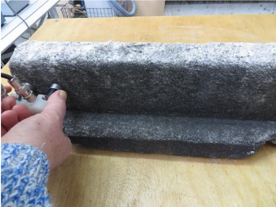
Abbildung 17: Oberflächenultraschallmessung auf der Kruste einer Marmoroberfläche
