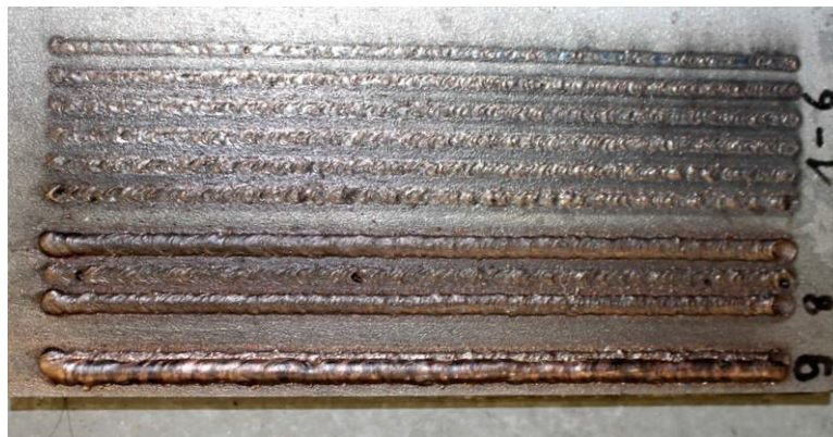
Abbildung 6: Erste Auftragsschweißungen mit einer Blei-Bronze-Legierung
