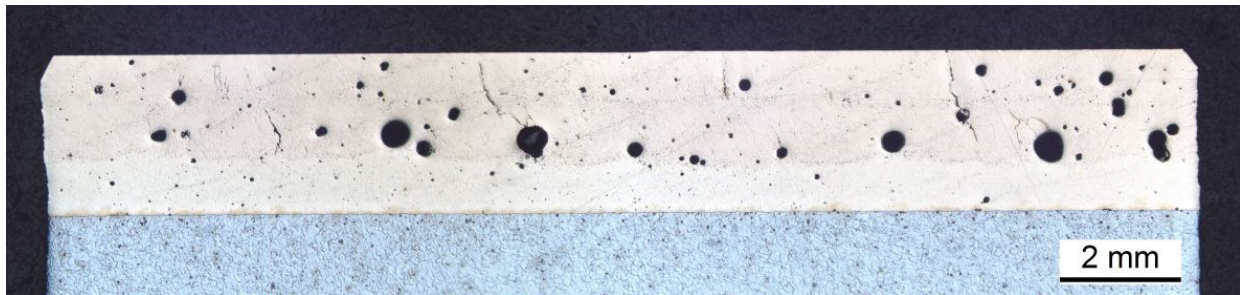
Abbildung 26: Probe 85 Beschichtung aus Pufferschicht und Deckschicht
