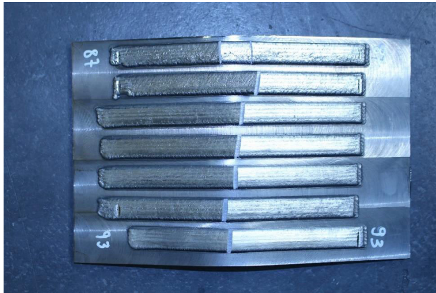
Abbildung 41: Proben 87 bis 93 - zweilagiger Schichtaufbau mit Parametern der Pufferlage von Probe 79
