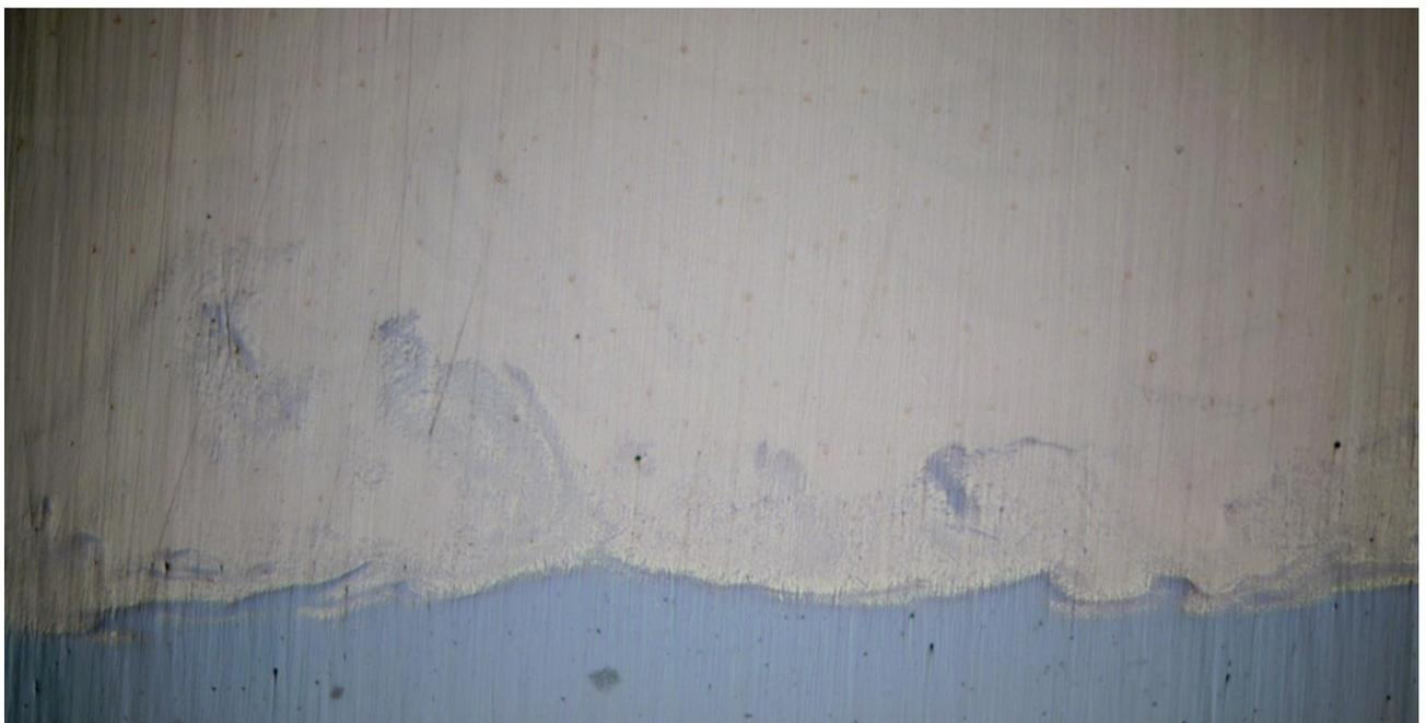
**Abbildung 25:** Querschliff CuAl ungeätzt; Bindungsbereich
