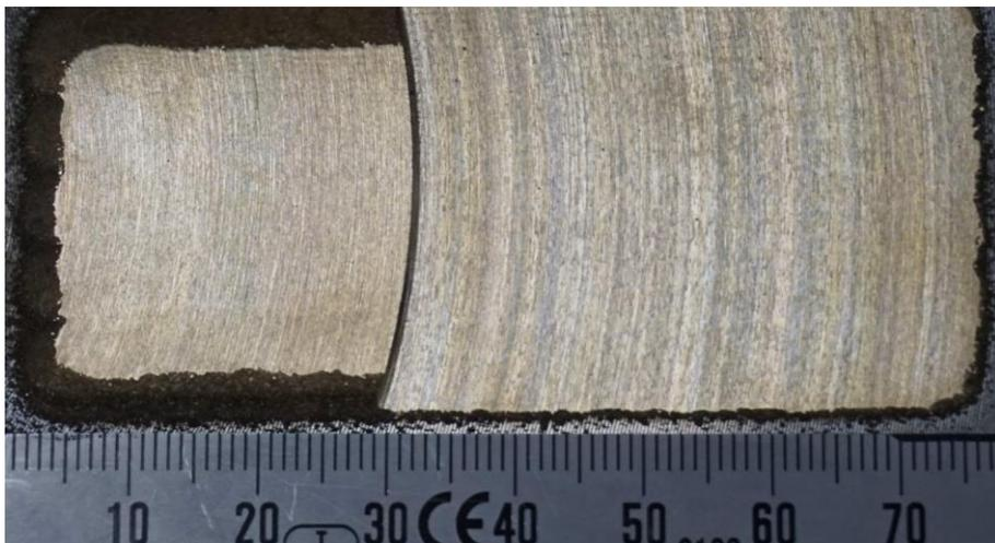
**Abbildung 13:** Probe 35; mit Versatz zw. Schichten; Übergangsbereich zw. Grund- und Deckschicht
