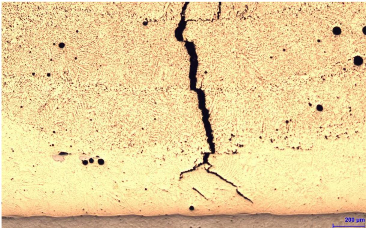
Abbildung 1: Riss in Auftragsschicht
