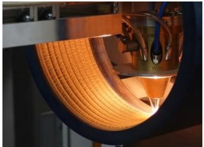
**Abbildung 29:** Innenbeschichtung  $\varnothing$  220 mm x 150 mm; C10 - CuAl; h = 2,5 mm; mehrlagig
