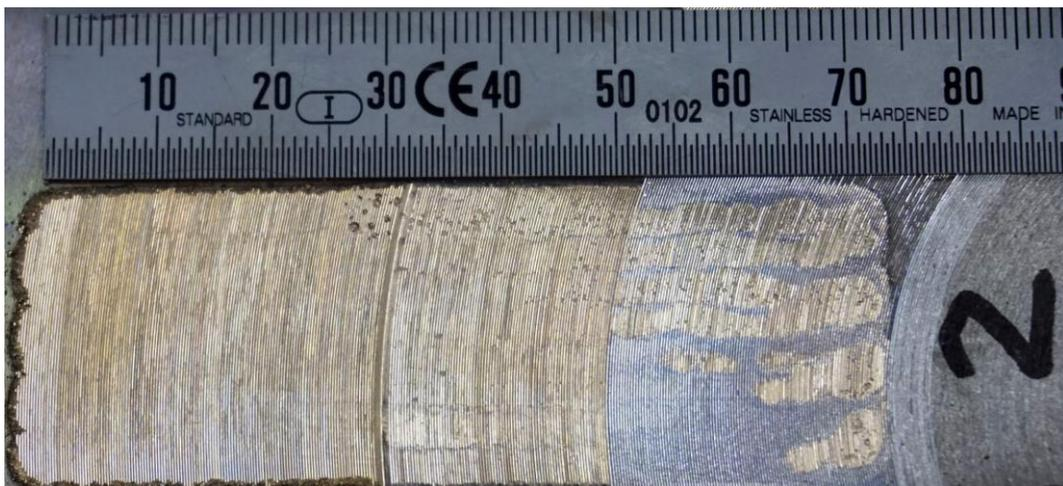
**Abbildung 9:** Probe 2, Porenbildung im stark durchmischten Bereich
