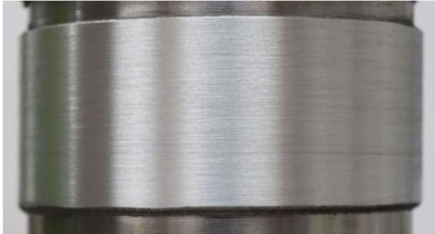
**Abbildung 32:** Bolzen  $\varnothing$  85 mm x 50 mm; C10 - AlSnCu; h = 2,5 mm mehrlagig
