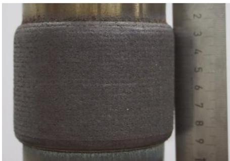
**Abbildung 3:** mehrlagig geschweißter Probeteppich
