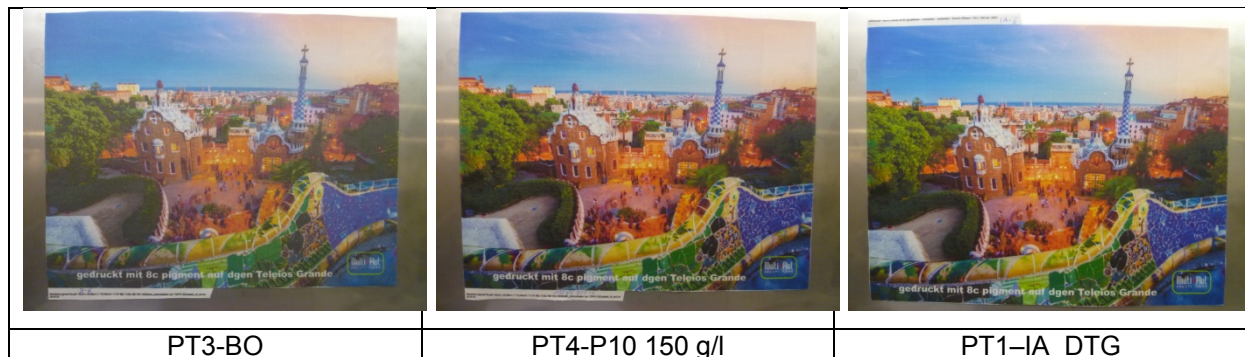
Abbildung 9: Druckresultate der ersten Versuchsreihe auf Baumwollware (schlechteste und beste Farbbrillanz)
