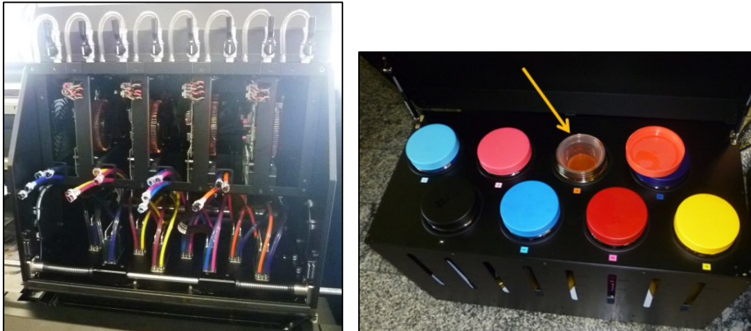
Abbildung 7: System zur Luftentfernung aus den Tintenschläuchen und acht Farbentanks mit Filter
