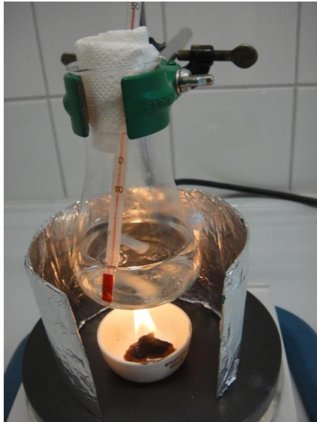
Abb. 2: Einfaches Kalorimeter zur Messung des Energiegehalts von Energieträgern
