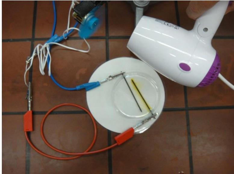
Abb. 6: Laden eines Zink-Iod-Akkus mit Strom aus Windenergie
