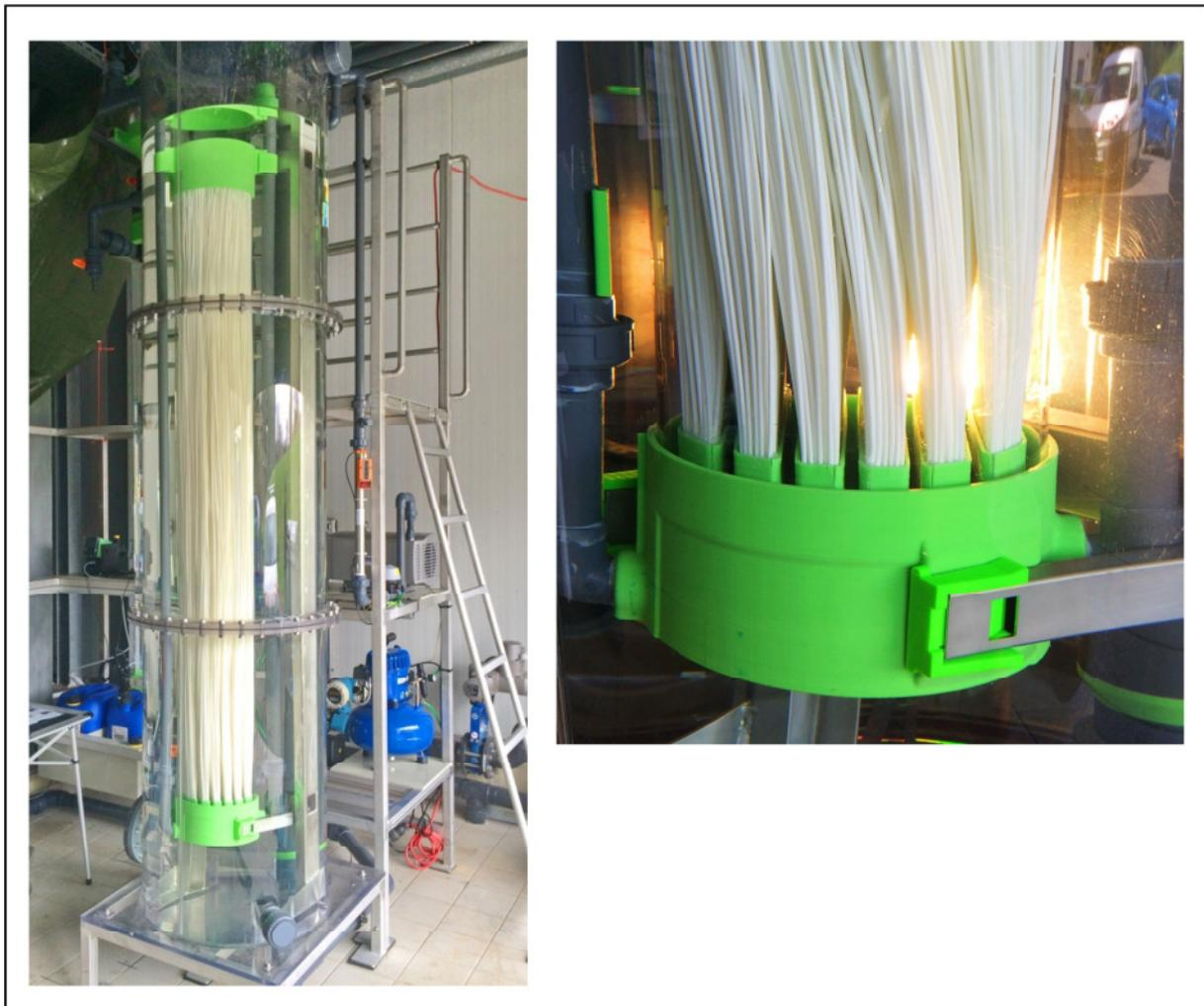
Bild 20: Pilotanlage mit eingebautem Funktionsmuster-Modul
