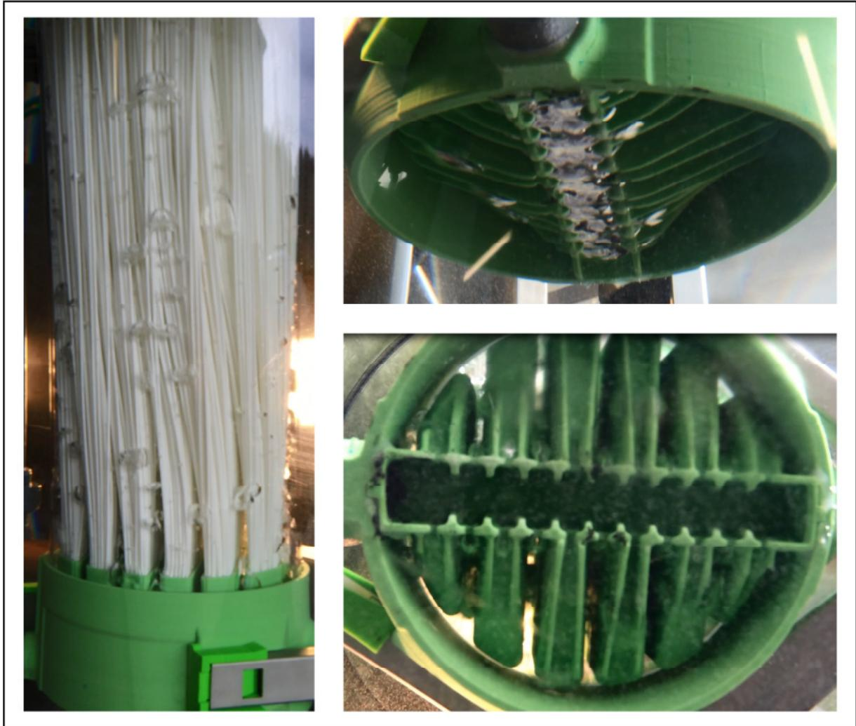
Bild 21: Belüftung des Moduls mit 5 m<sup>3</sup>/h
