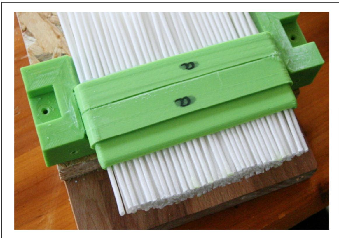
Bild 6: Potting-Verfahren des Membion Membranfilters
