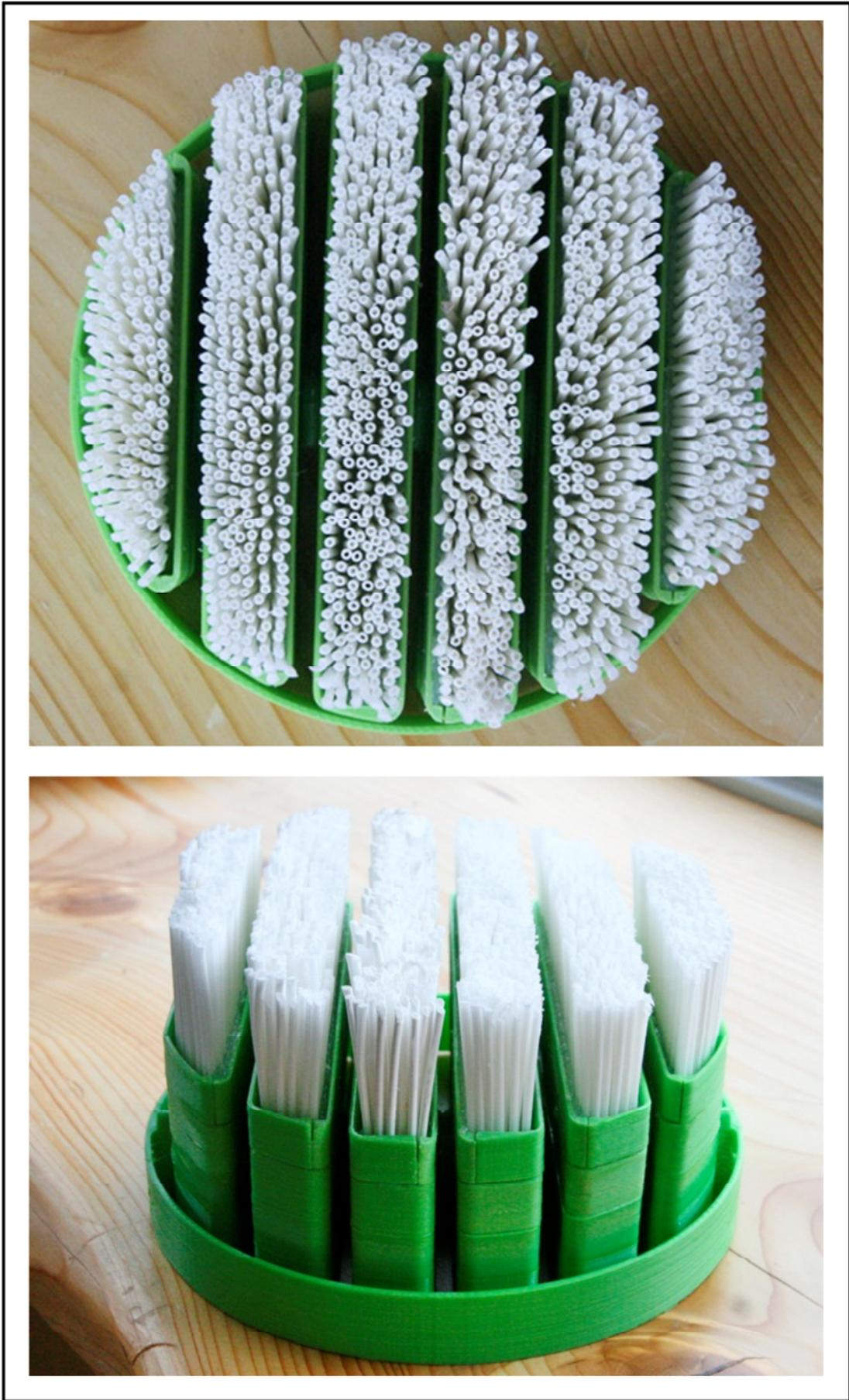
Bild 9: Ergebnisse der Einharz-Tests eines ganzen Modulfußes
