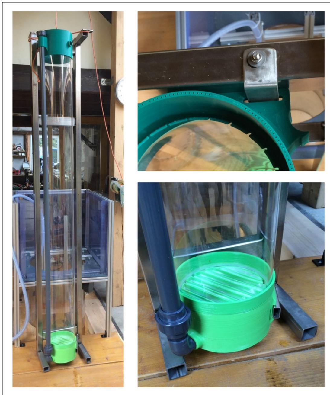
Bild 12: Optimierung der Befestigung des Modulrohres im Modulrahmen
