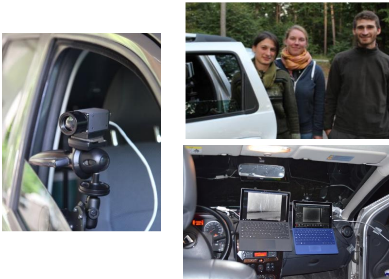
Abb. 8: Die Wärmebildkameras werden auf beiden Seiten des PKWs angebracht. Im Inneren des Autos sind Laptops zur Wiedergabe der Kamerabilder installiert.
