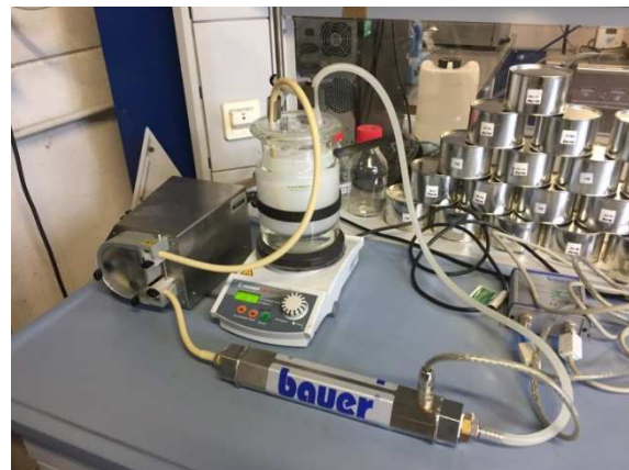
Abbildung 3.1.8: links: Verlauf der Trimethoprimkonzentration über die Zeit, Vorlage temperiert auf 20 \text{ }^\circ\text{C} , \text{pH } 8,0-8,3 ; zwei identische Versuchsdurchläufe mit Behandlung, ein Referenzverlauf ohne Behandlung; rechts: Versuchsaufbau zur Analyse des Einflusses des Bauersystems auf die Löslichkeit von Trimethoprim in vollentsalztem Wasser
