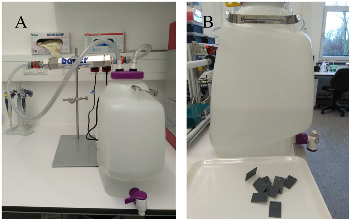
Abbildung 3.4.12. Zirkulierende Versuchsmodelle im Labor Stufe 2. Links wird der komplette Aufbau des Versuchsmodells gezeigt (A). Rechts werden die PVC-Abschnitte vor Versuchsbeginn dargestellt.
