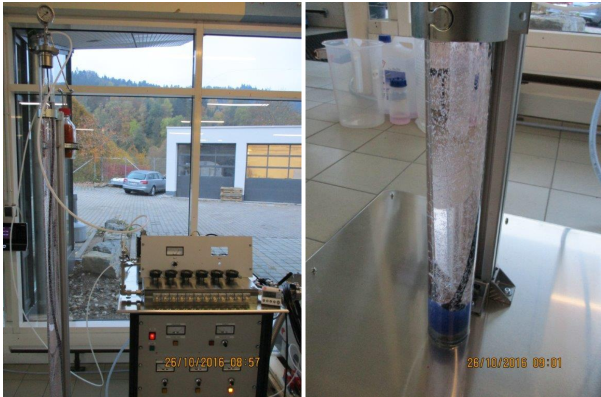
Abb. 10: Testaufbau mit Waschsäule für quantitative Messungen
