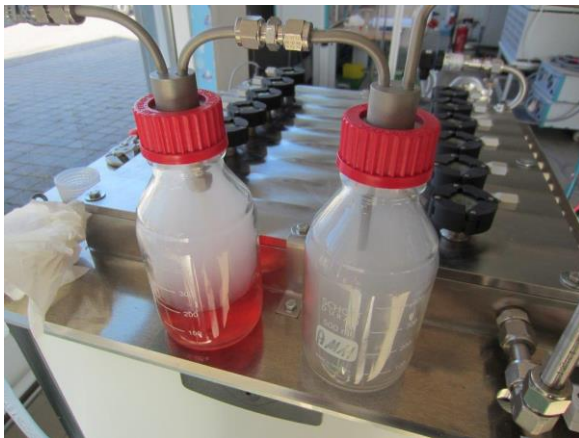
Abb. 9: Erste Ergebnisse der Vorversuche - Nebelbildung oberhalb der Lauge
