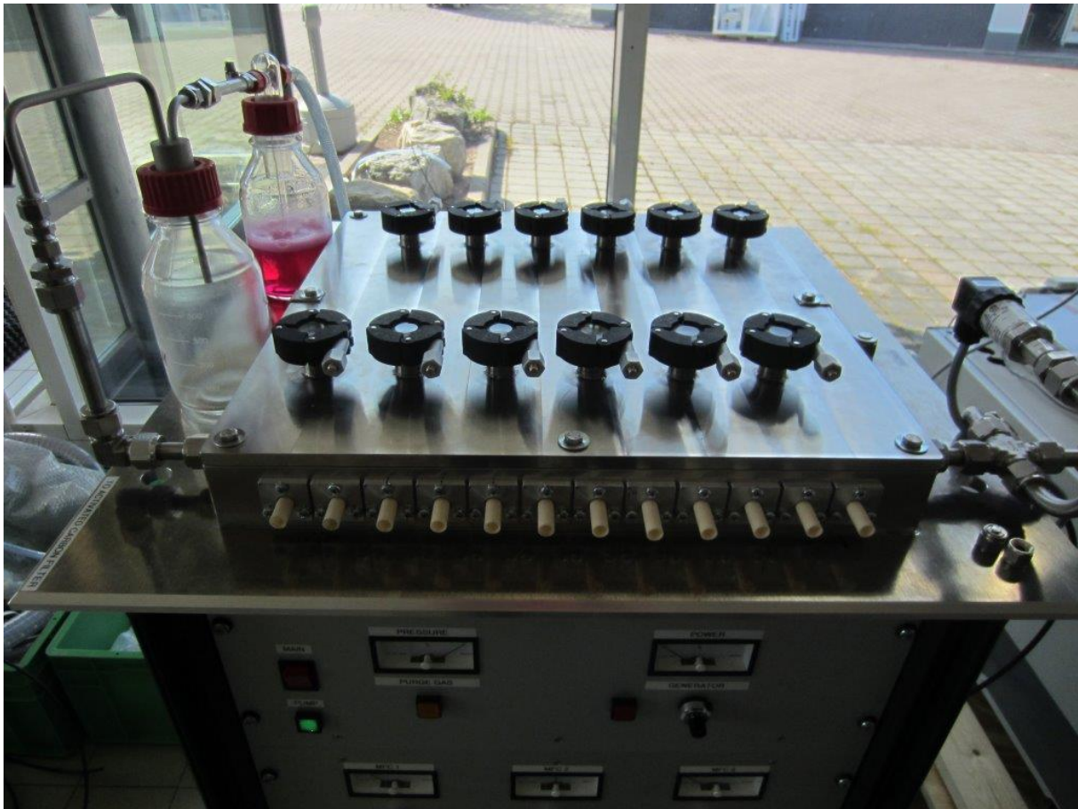
Abb. 7: Aufbau für die Vorversuche (mit Sicherheitsflasche und Gaswaschflasche mit Fritte am Ausgang)
