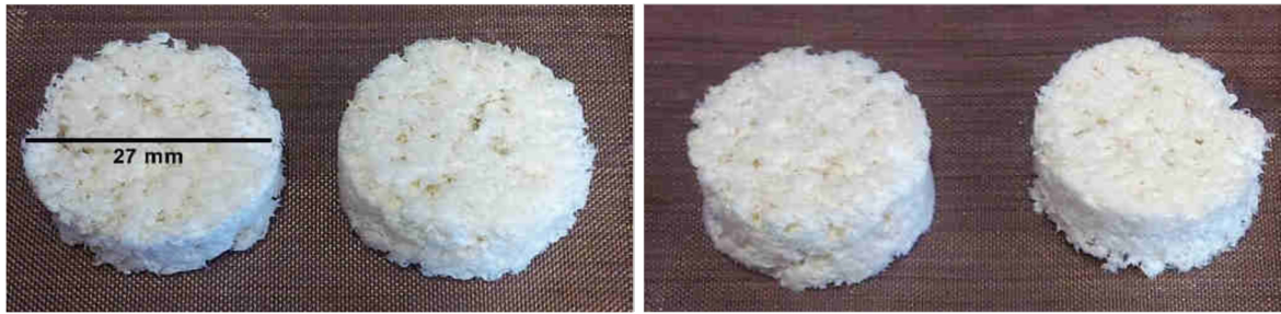
Abbildung 12: Durch Heißpressen bei 140°C hergestellte PEI-Cellulose-Pellets.
