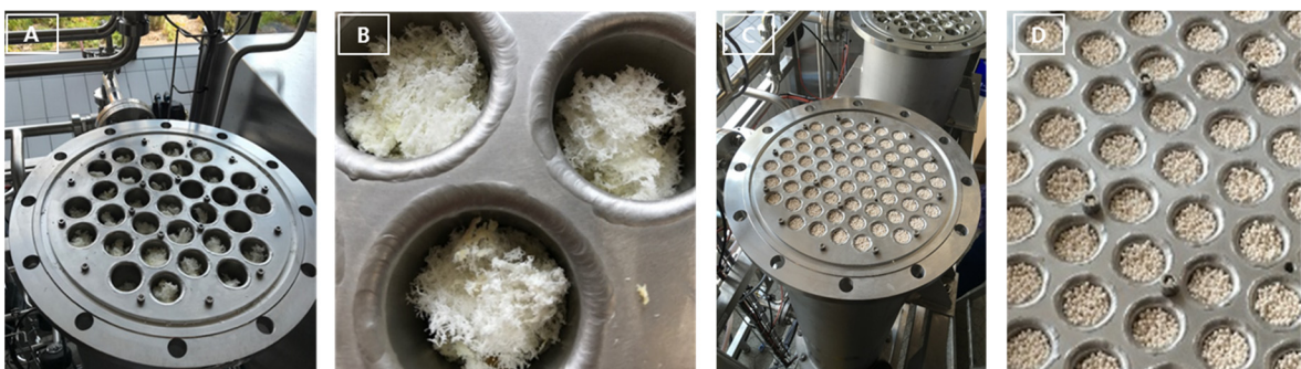
Abbildung 29: Befüllung der Rohrbündelreaktoren mit den Adsorbentien: (A,B) Cellulosematerial; (C,D) Zeolith.
