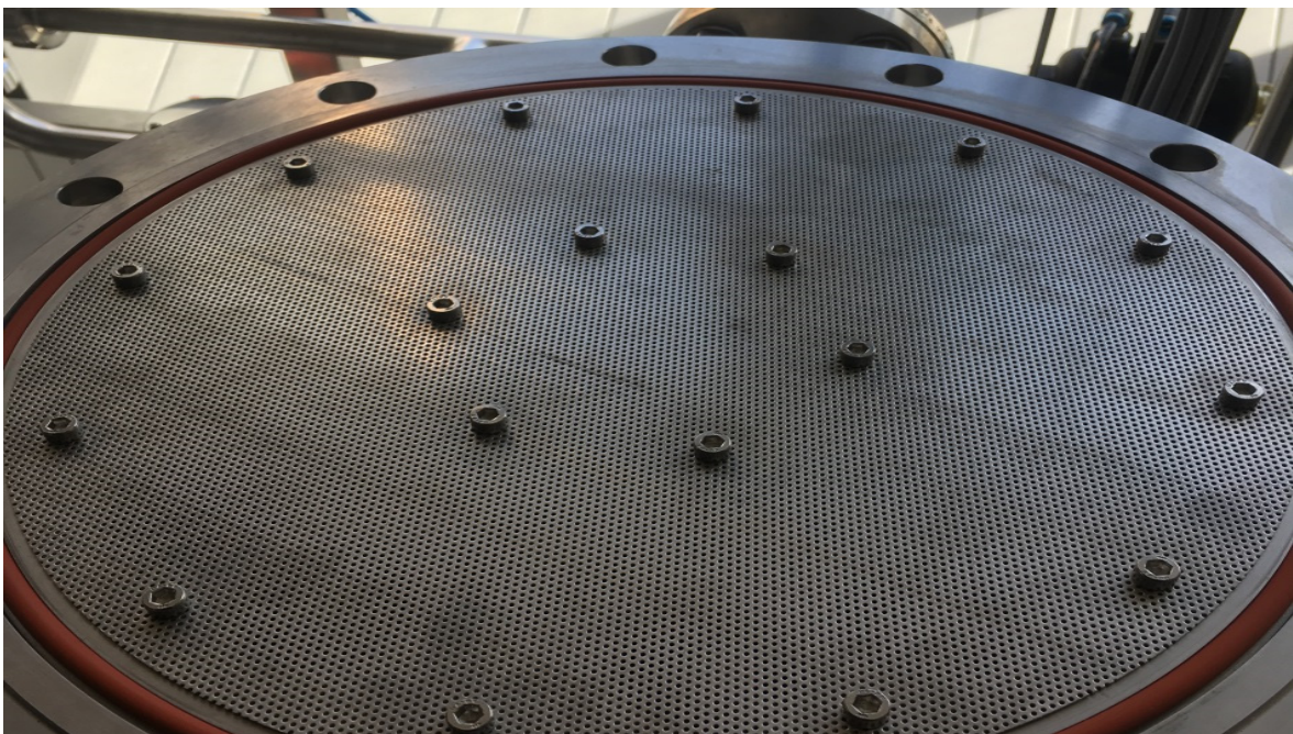
Abbildung 23: Siebplatte im Reaktor über Rohrbündel.
