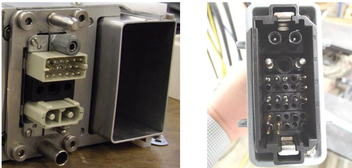
Abbildung 15: Links: Foto der Schnittstellen des luftgekühlten Aggregates
