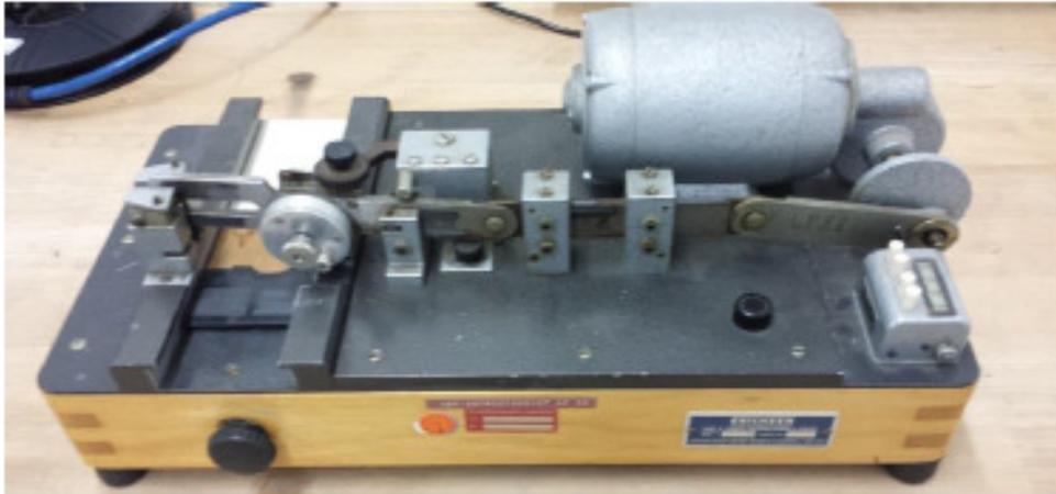
Abbildung 7: Abriebprüfgerät
