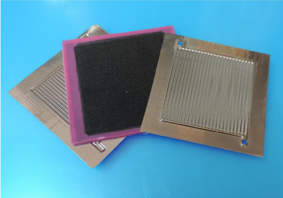
Abb. 10: MEA – liegend zwischen 2 Bipolarplatten
