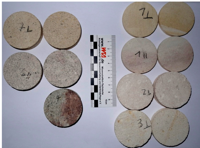
Abb. 18 Probekörper-Bohrkernscheiben für die Durchführung naturwissenschaftlicher Untersuchungen
