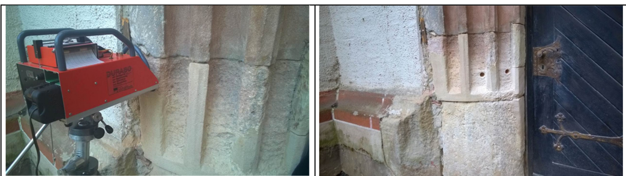
Abb. 21 Bohrwiderstandsmessungen und Entnahme kleiner Bohrkern an Musterflächen mit verschiedenen Steinfestigern zur Untersuchung
