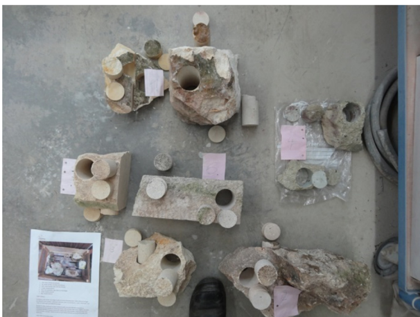
Abb. 12 Herstellung von Probekörpern unterschiedlicher Tuff-Varietäten zur Bestimmung von Materialkennwerten
