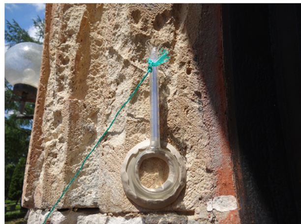
Abb. 11 Bestimmung der Wasseraufnahme nach Karsten am Musterportal
