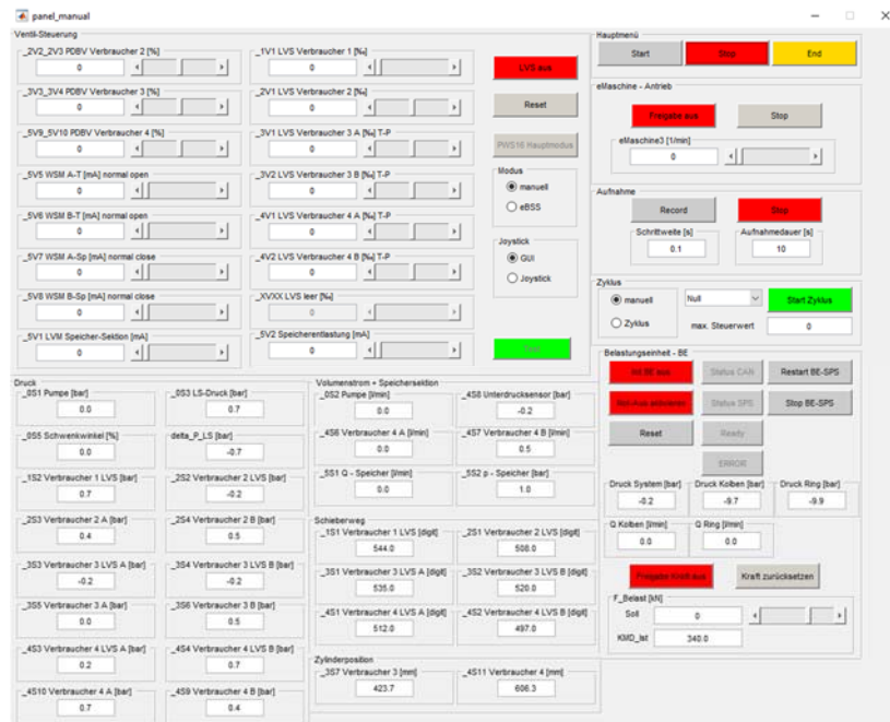
Abbildung 3.1.3: Nutzerschnittstelle zur Steuerung und Überwachung des Prüfstands und der Belastungseinheit
