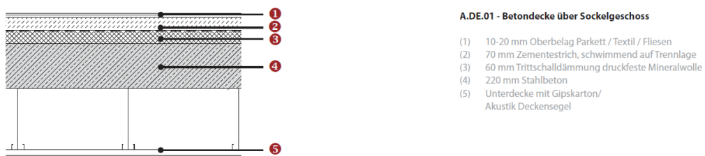
Abbildung 30: Aufbau der Decke über dem Untergeschoss (IBUS Architekten)
