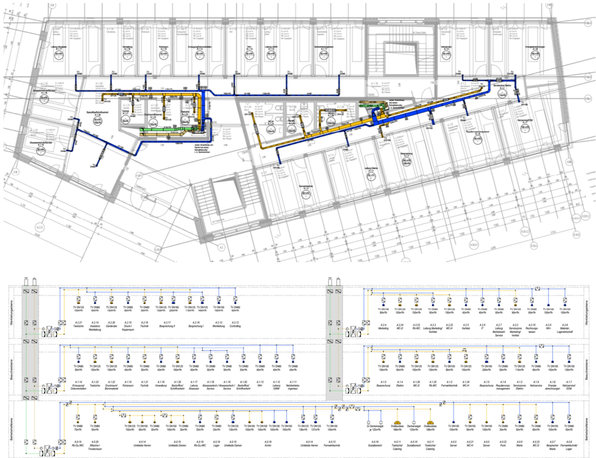
Abbildung 57: Exemplarische Darstellung der Lüftungstechnik EG Haus A und Strangschema Lüftung Haus A, (Ingenieurbüro TAUBE + GOERZ GmbH)
