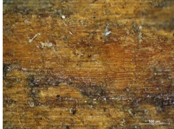
Abbildung 26b: Holzartige Oberfläche nach dem Einsatz des UltrakurzpulsLasers (800 nm, 30 fs, F_0 = 0,13 \text{ J/cm}^2 N_{\text{eff}} = 10 ). Größe des Messbalkens unten rechts: 500 µm. Bild: BAM.
