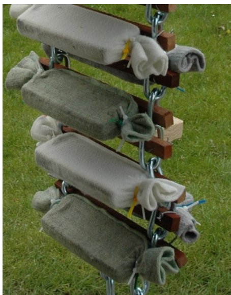
Abbildung 1: Modifizierte Versuchsanordnung von Geotextil ummantelten Normprüfkörpern.
