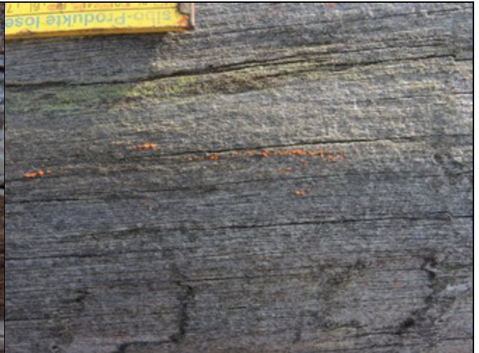
Abb. 22: Braunfäule-Erreger: Zerfließende Gallerträne ( Dacrymyces stillatus ); P5: Fundstelle: Yacht-Zentrum Störtebeker GmbH; Pfahl (NO): 9; 10-25 cm unter der Spitze (Bild: T. Huckfeldt).
