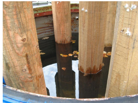
Abbildung 17: Vorratstank für Salzwasser mit Förderpumpe (links) und nahezu vollständig mit Salzwasser befüllter Stahlzylinder kurz vor Versuchsstart (rechts).
