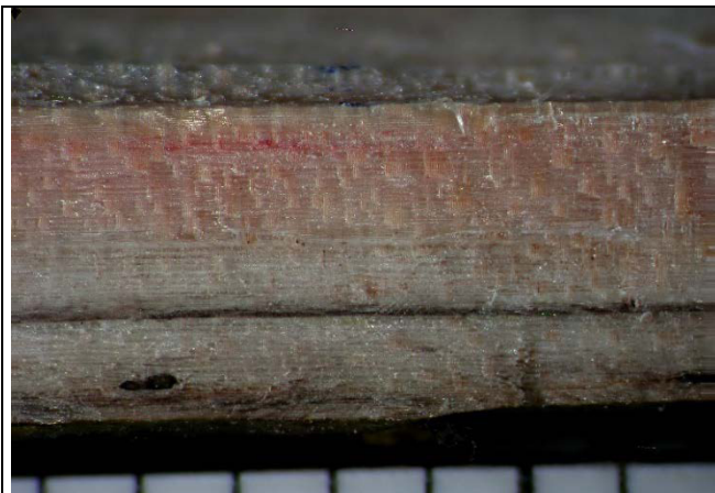
Abbildung 10: Rundholz Nr. 2 - Befall von außen (im Bild unten) nach innen abnehmend (Bild: T. Huckfeldt).
