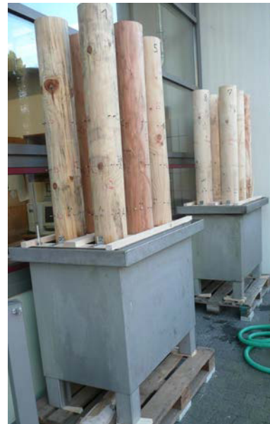
Abbildung 19: Einbau und Fixierung der Testhölzer im Container (links) sowie vollständigem Versuchsaufbau (rechts).
