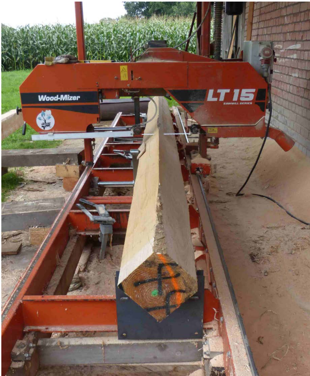
Abbildung 13: Herstellung eines Kantholzes im Achteckquerschnitt auf einem Wood-Mizer LT 15.
