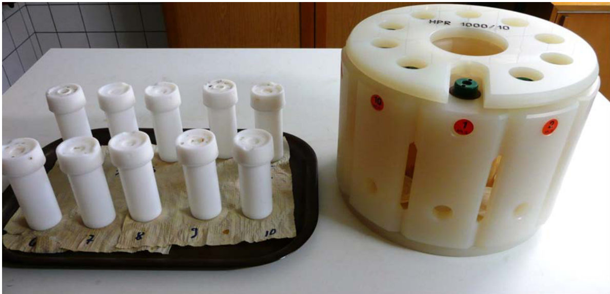
Abbildung 22: Aufschlussgefäße und Mikrowellenaufschlussblock.
