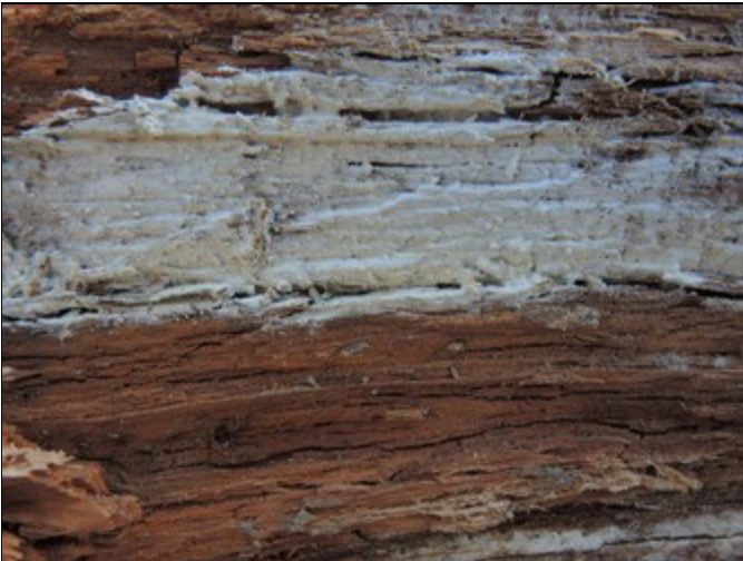
Abb. 21: Karstens Rindenpilz ( Dacryobolus karstenii ), Fundstelle: P6: Yacht-Zentrum Störtebeker GmbH; Pfahl: 9 (SW-SO); (0-) 20-30 cm unter der Spitze (Bild: T. Huckfeldt).
