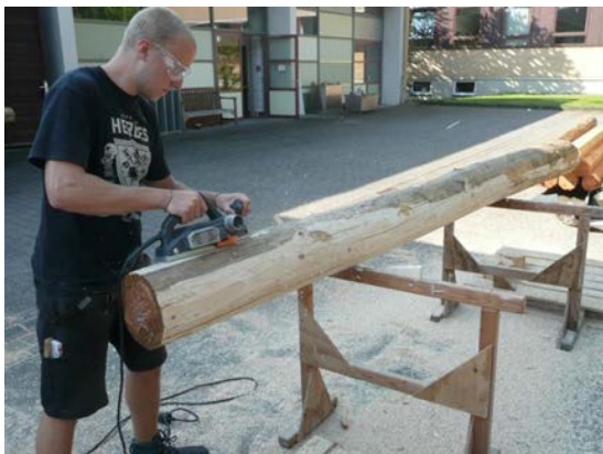
Abbildung 15: Vorbereitung der Stämme für das Setzen der Messelektroden (links) und achteckige Nadelholzstämmen (rechts).
