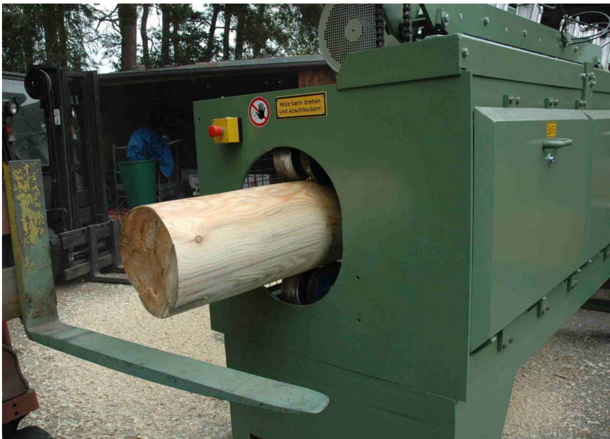
Abbildung 12: Maschinelles Rundfräsen der Versuchshölzer.
