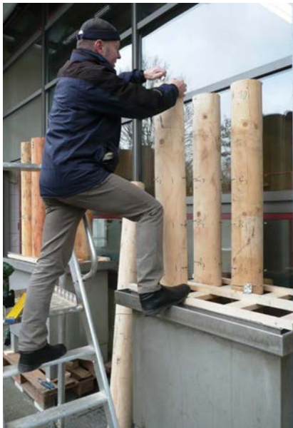
Abbildung 19: Einbau und Fixierung der Testhölzer im Container (links) sowie vollständigem Versuchsaufbau (rechts).
