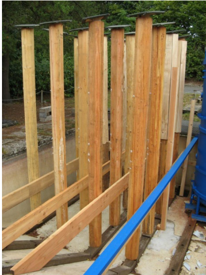
Abbildung 16: Stützkonstruktion zur Sicherung der Stämme und Gewährleistung des Begehbarkeit sowie vollständig eingerichtetes Prüffeld.
