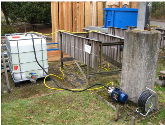
Abbildung 17: Vorratstank für Salzwasser mit Förderpumpe (links) und nahezu vollständig mit Salzwasser befüllter Stahlzylinder kurz vor Versuchsstart (rechts).
