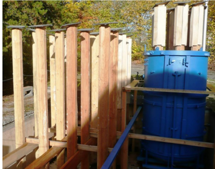
Abbildung 16: Stützkonstruktion zur Sicherung der Stämme und Gewährleistung des Begehbarkeit sowie vollständig eingerichtetes Prüffeld.
