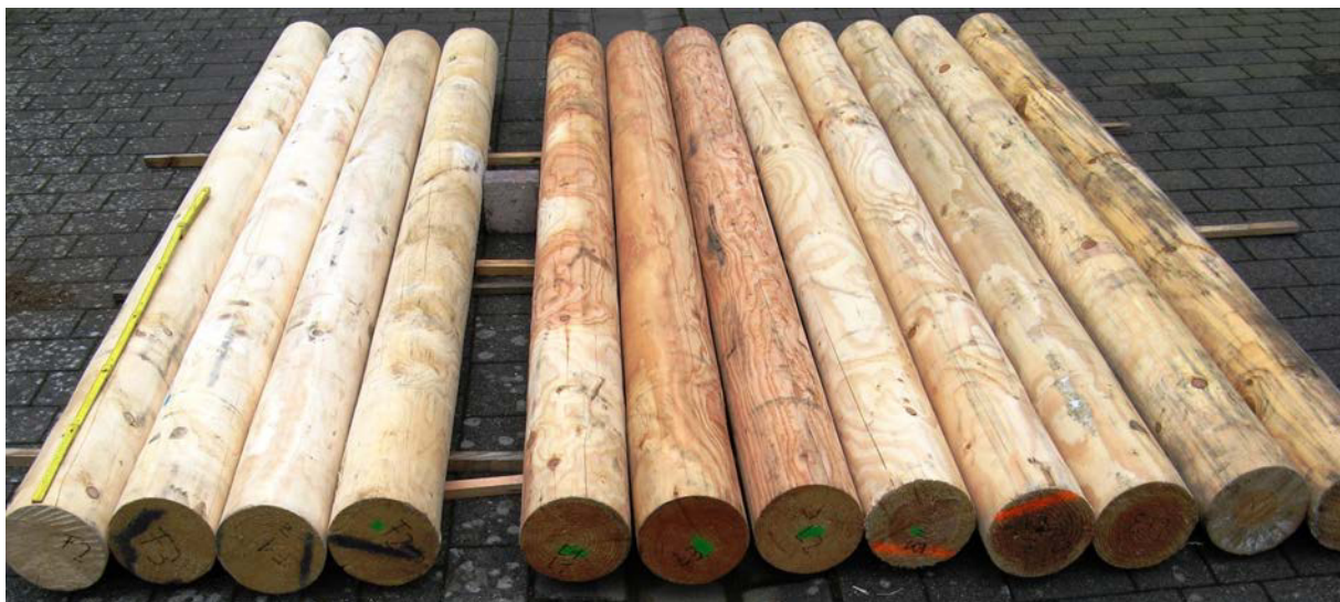
Abbildung 18: Entrindete rundgefräste Nadelhölzer (Durchmesser ca. 18 cm) vor dem Einbau in die Edelstahl tanks (Abbildung 19).
