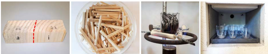
Abbildung 21: Ablaufschema - Probenriegel (noch nicht separiert), zerkleinertes Probenmaterial im Quarztiegel, Veraschen des Materials in einem Tiegel über dem Bunsenbrenner und anschließendes Ausglühen im Muffelofen (Robbers 2018).
