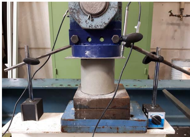
Abbildung 4-2: Versuchseinrichtung zur Bestimmung der Druckfestigkeit
