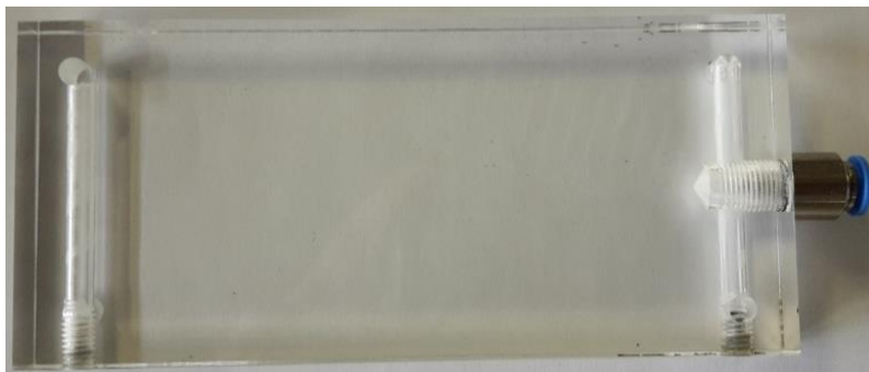
Abbildung 4-31: Draufsicht Acrylplatte mit Fluidkanälen
