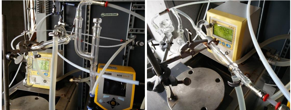
Abbildung 4-3: Kondensatoren: Koaxialrohr »großer« Querschnitt (links) Koaxialrohr »kleiner« Querschnitt (rechts)
