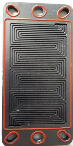
Abbildung 4-8: Bipolarplatte mit Sicht auf das Flowfield
