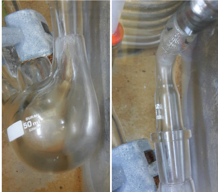
Abbildung 4-22: Kondensatbildung im Labor-Glaskolben; links: vereinzelt kleine Kondensattröpfchen im Glaskolben, rechts: Kondensatbildung am Eintritt in den Kondensator (die Aufnahmen wurden jeweils um 14:18 Uhr aufgenommen)
