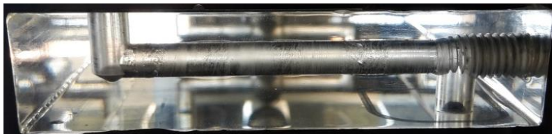
Abbildung 4-32: Frontansicht Acrylplatte mit Fluidkanälen
