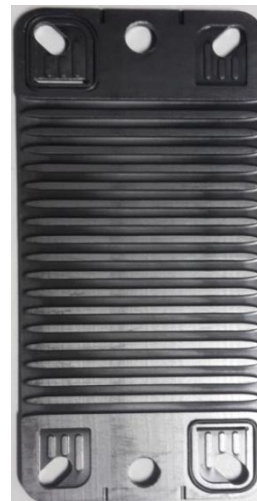
Abbildung 4-9: Bipolarplatte mit Sicht auf die Kühlrippen (Luft)
