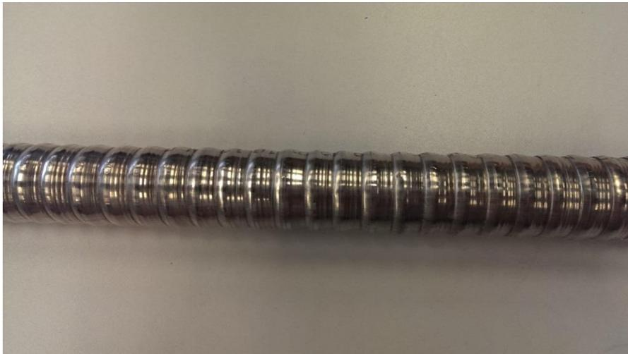
Abbildung 32: Asymmetrisches Querrillenrohr
