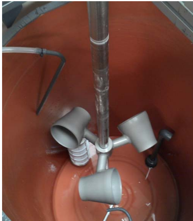
Abbildung 13: Eingesetzter Becherrührer zur Minimierung des Energieeintrags bei gleichzeitig homogener Durchmischung des Eisbreis
