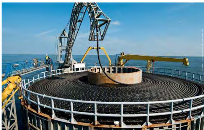
Ein Drehstromkabel von 60 km Länge und 3.500 t Gewicht bindet den ersten deutschen Offshore-Windpark alpha ventus an das deutsche Stromnetz an
